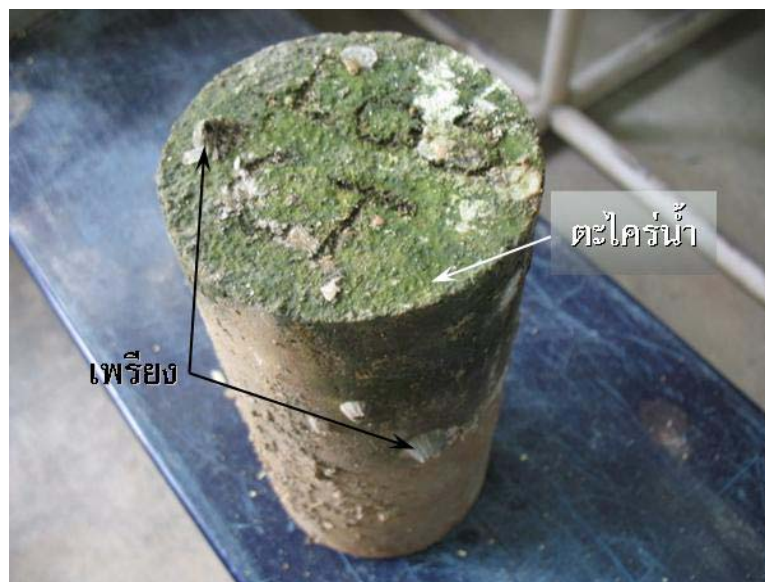
(ข) เฟรียง และตะไคร่น้ำที่ติดอยู่ตามผิวคอนกรีต
