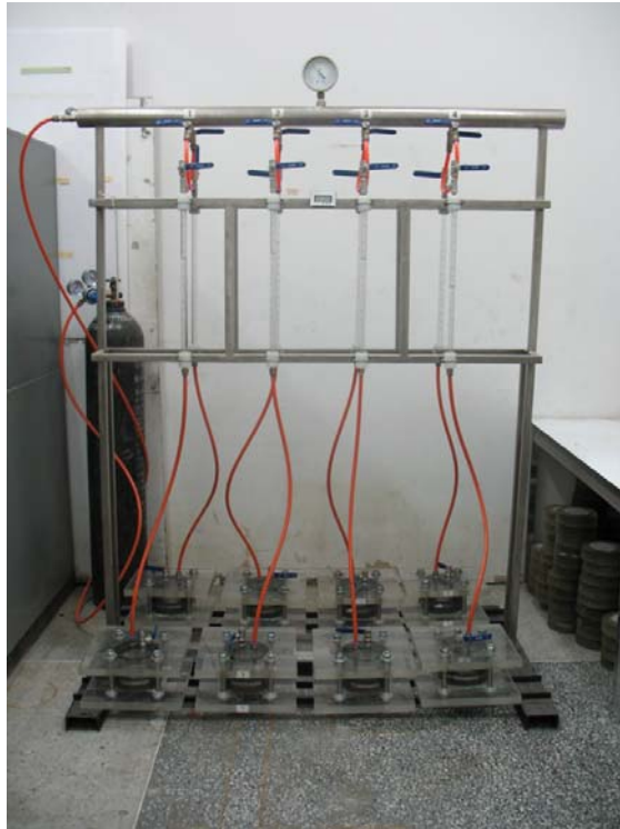
รูปที่ 3.3 เครื่องทดสอบการซึมน้ำผ่านคอนกรีต
