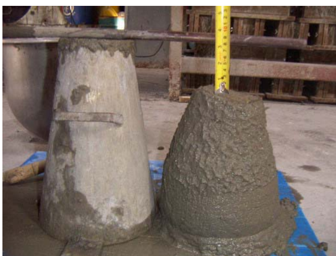
ภาพที่ 21 การทดสอบค่าการยุบตัวโดยควบคุมค่ายุบตัวที่ 7.5 \pm 2.5 ซม.
