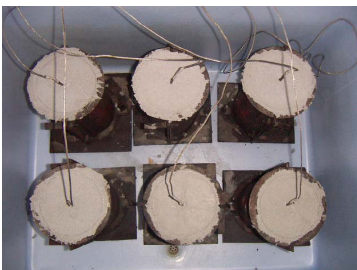
ภาพที่ 23 เครื่องมือสำหรับบันทึกอุณหภูมิและการติดตั้งเทอร์โมคอปเปิ้ลในตัวอย่างคอนกรีต
