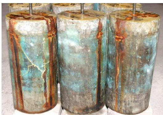
ภาพที่ 29 การเกิดการแตกร้าวของคอนกรีตควบคุมที่อายุต่างๆ
