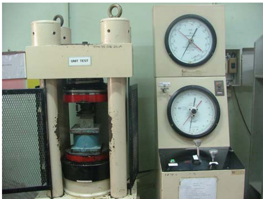
ภาพผนวกที่ ข6 การทดสอบกำลังอัดของคอนกรีต
