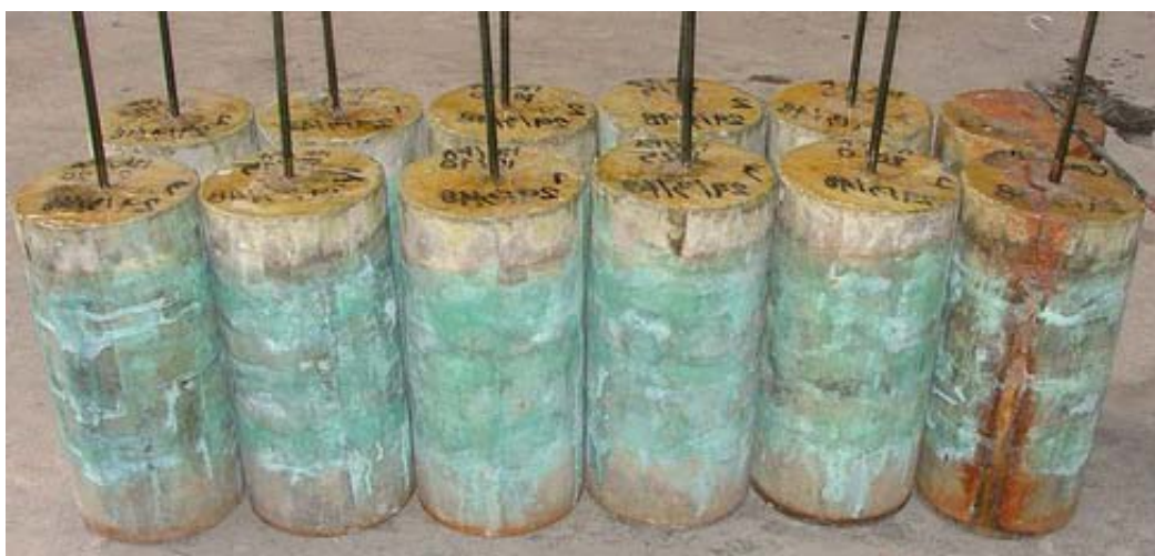
คอนกรีตผสมดินขาวและเถ้าลอยเร่งสนิมด้วยกระแสไฟฟ้าระยะเวลา 140 วัน
