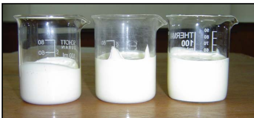
B : กาวยางผสม Terpene phenolic resin ปริมาณต่างๆ : (1) 45 phr (2) 60 phr (3) กาวยางผสม Petroleum resin 15 phr
