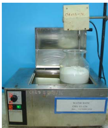
ภาพประกอบที่ 23 แสดงชุดอุปกรณ์สำหรับเตรียมน้ำยางธรรมชาติอีพอกไซด์
