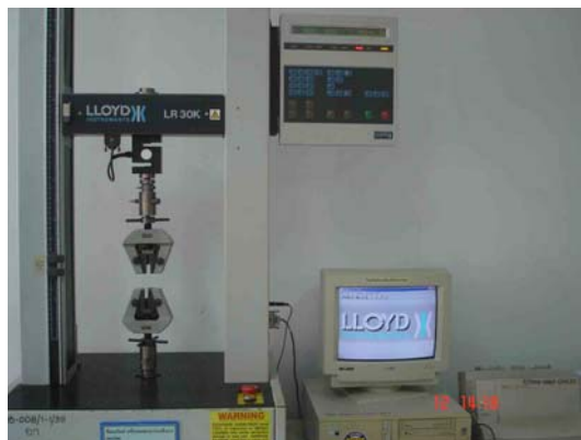
ภาพประกอบที่ 26 แสดงเครื่องทดสอบสมบัติด้านการดึง
