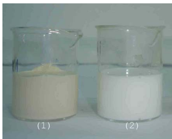
ภาพประกอบที่ 35 แสดงคิวมาโรน อินดิน เรซินในรูปอิมัลชัน (1) แป้งข้าวเหนียวเจลาตินไนซ์ (2)
