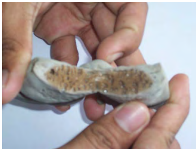
รูปที่ 17 STR20 ความหนา 2 cm หลังการผ่านคลื่นที่ 1,000 W 150 °C (ด้านใน)
