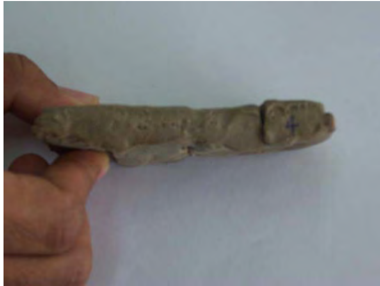
รูปที่ 12 STR20 ความหนา 2 cm หลังการผ่านคลื่นที่ 1,000 W 100 °C (ด้านข้าง)
