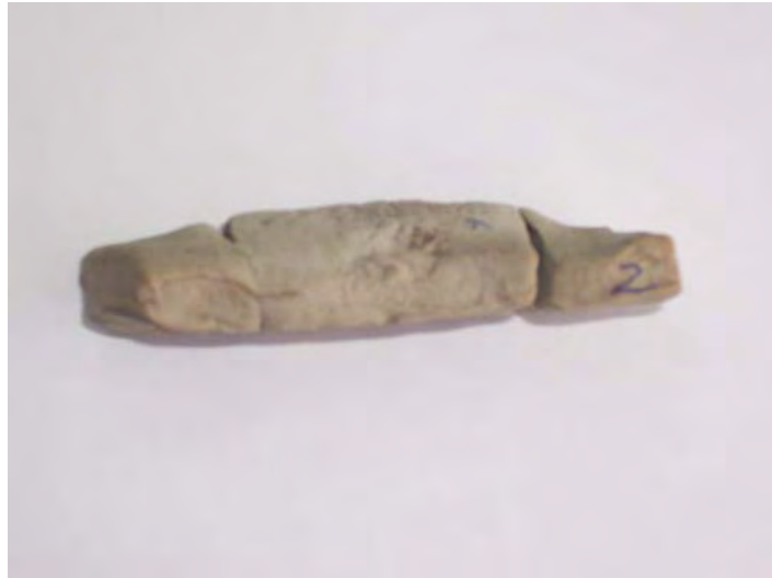
รูปที่ 16 STR20 ความหนา 2 cm หลังการผ่านคลื่นที่ 1,000 W 150 °C (ด้านข้าง)
