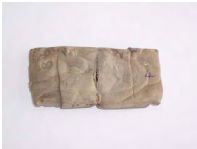
รูปที่ 11 STR20 ความหนา 2 cm หลังการผ่านคลื่นที่ 1,000 W 100 °C (ด้านบน)
