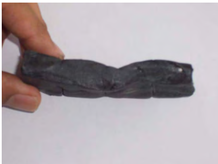
รูปที่ 20 STR20-Carbon black ความหนา 2 cm หลังการผ่านคลื่นที่ 1,000 W 150 °C (ด้านข้าง)
