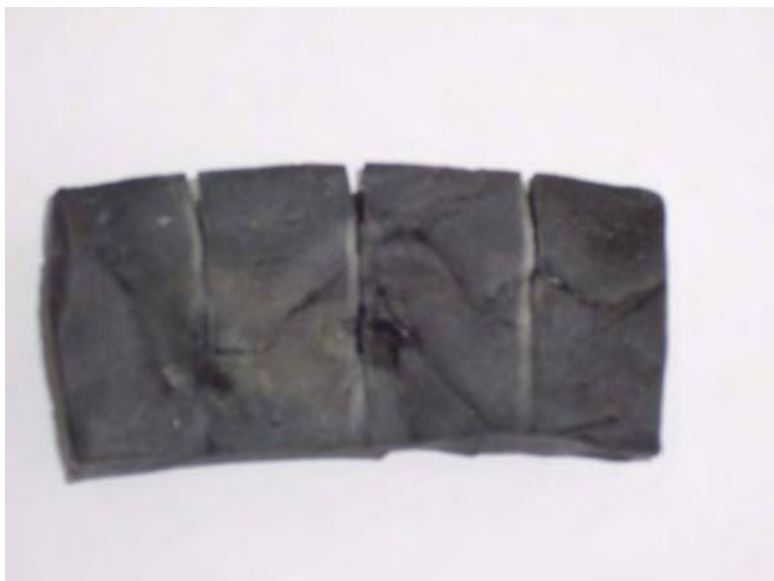
รูปที่ 18 STR20-Carbon black ความหนา 2 cm หลังการผ่านคลื่นที่ 1,000 W 150 °C (ด้านล่าง)
