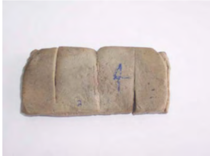
รูปที่ 10 STR20 ความหนา 2 cm หลังการผ่านคลื่นที่ 1,000 W 100 °C (ด้านล่าง)
