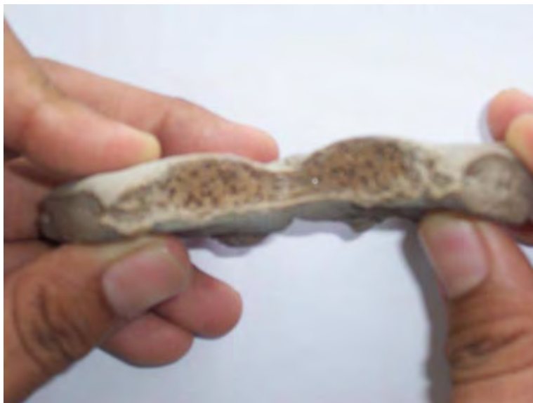
รูปที่ 13 STR20 ความหนา 2 cm หลังการผ่านคลื่นที่ 1,000 W 100 °C (ด้านใน)
