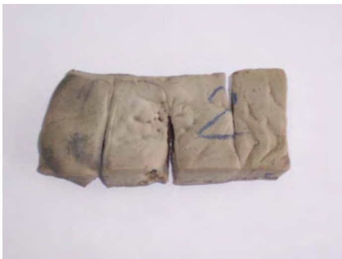
รูปที่ 15 STR20 ความหนา 2 cm หลังการผ่านคลื่นที่ 1,000 W 150 °C (ด้านบน)
