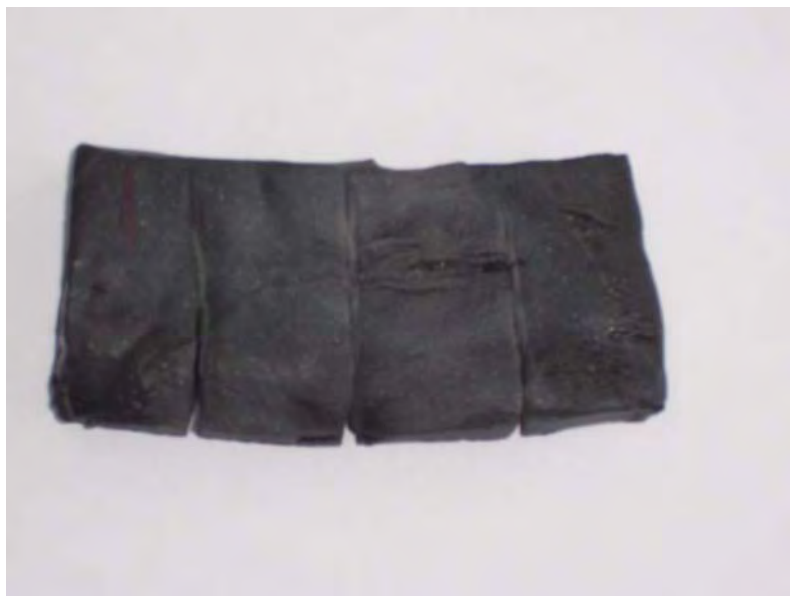
รูปที่ 19 STR20-Carbon black ความหนา 2 cm หลังการผ่านคลื่นที่ 1,000 W 150 °C (ด้านบน)
