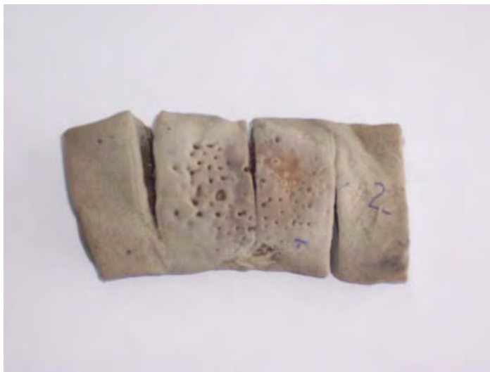
รูปที่ 14 STR20 ความหนา 2 cm หลังการผ่านคลื่นที่ 1,000 W 150 °C (ด้านล่าง)
