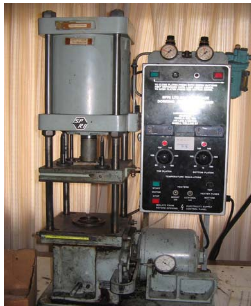
รูปที่ 5 เครื่องมูนนี่วิสโคมิเตอร์ (Mooney Viscometer)
