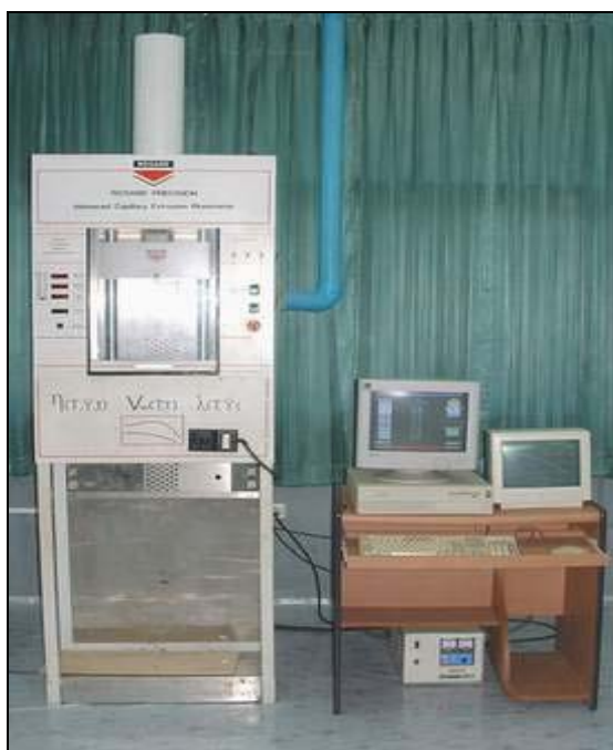
รูปที่ 6 ลักษณะของเครื่องรีโอมิเตอร์ แบบ Rosand Capillary Rheometer
