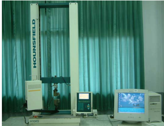
รูปที่ 8 ลักษณะของเครื่อง Tensometer
