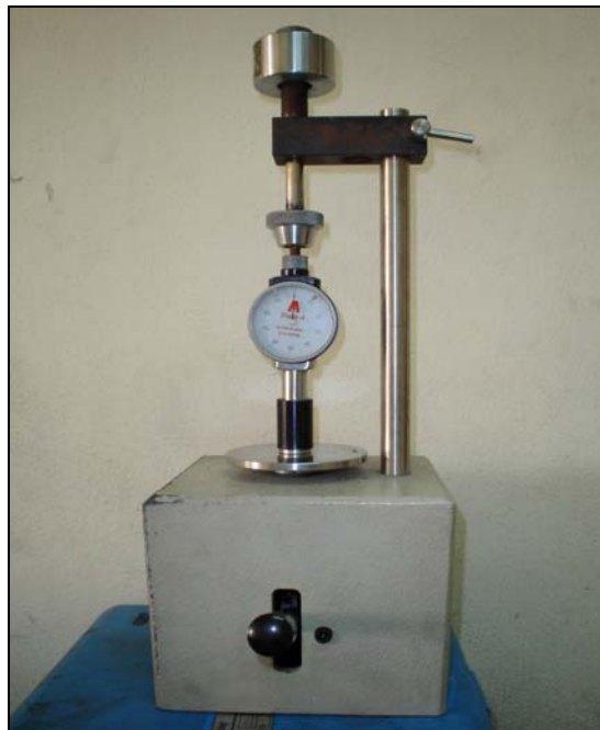
รูปที่ 9 เครื่องวัดความแข็งแบบ Shore A
