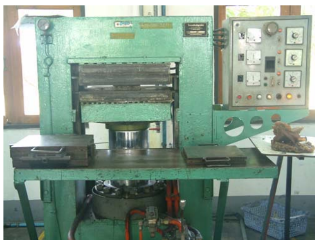
รูปที่ 2 เครื่องอัดเบ้า (Compression Moulding)
