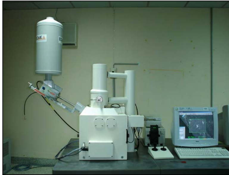
รูปที่ 10 กล้องจุลทรรศน์อิเล็กตรอนแบบส่องกราด (Scanning Electron Microscope, SEM)
