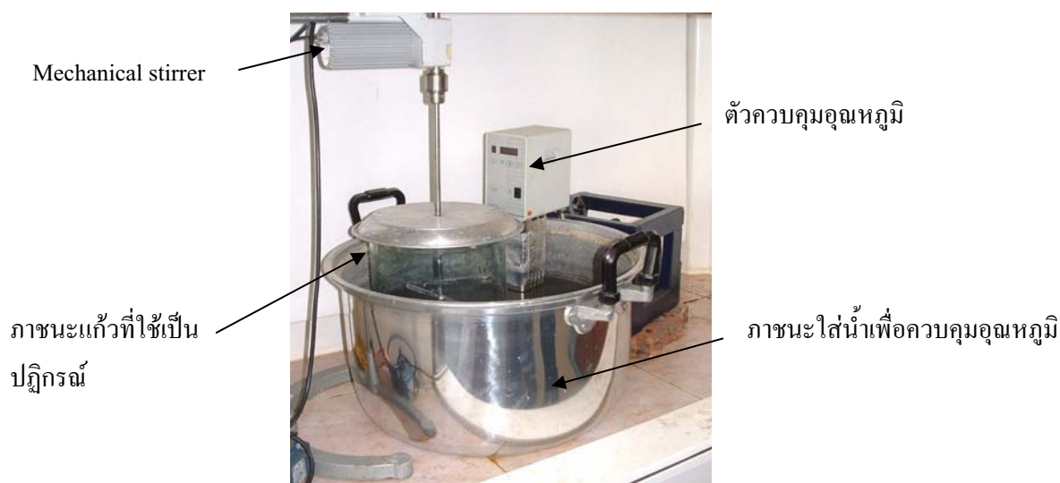
รูปที่ 1 ชุดอุปกรณ์ที่ใช้ในการเตรียมยางธรรมชาติอิพอกไซด์
