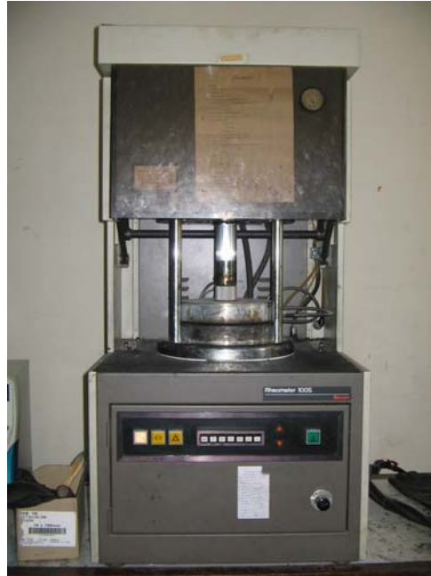
รูปที่ 7 ลักษณะของเครื่อง ODR 100S สำหรับทดสอบสมบัติการวัลคาไนซ์
