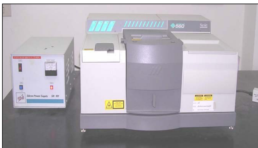
รูปที่ 3 ลักษณะของเครื่องอินฟราเรดสเปกโตรโฟโตมิเตอร์ รุ่น Omnic ESP Magna-IR 560
