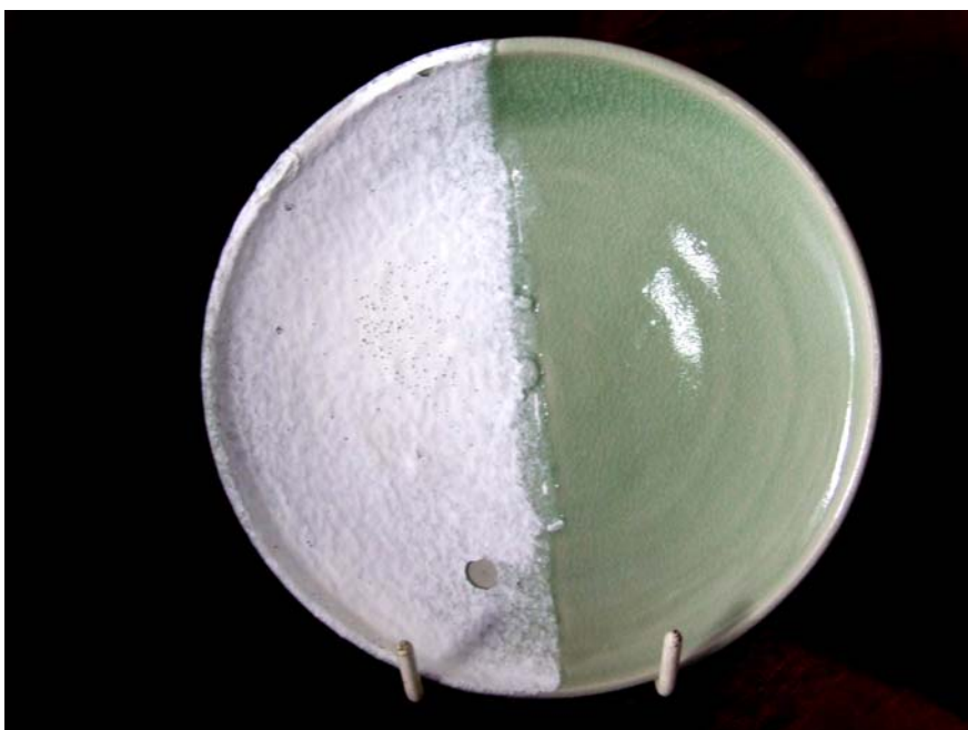
ภาพที่ 4.27 แสดงการใช้เทคนิคพ่นทับเคลือบสีลาดด้วยดินขาวระนอง เคลือบเกิดการพองตัว ( สูตรเริ่มต้นของนายธีระพงษ์ ไชยอ้าย )
