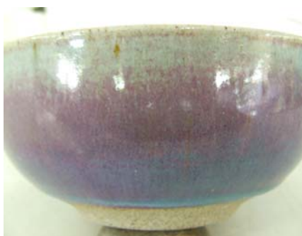
ภาพที่ 2.4 แสดงการไหลคล้ายขนแมว
