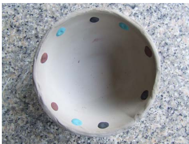
ภาพที่ 4.25 การจุดสีออกไซด์แต่ละสีไว้ด้านบนภาชนะ
