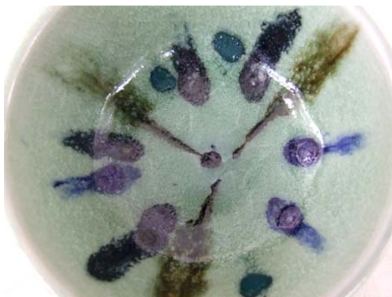
ภาพที่ 4.26 แสดงการไหลตัวของสีออกไซด์
