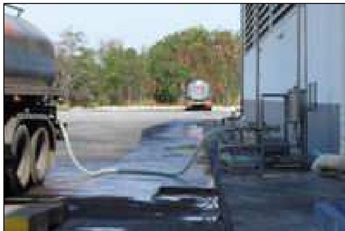
รูปที่ 1.4 : แสดงกระบวนการลำเลียงนํ้านมดิบจากรถบรรทุกเข้าสู่ท่อลงสู่ถังพักนม
