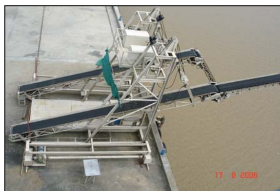
รูปที่ 4.7(1) และ (2) เครื่องลำเลียงน้ำตาลแบบกระสอบลงสู่เรือโป๊ะ
