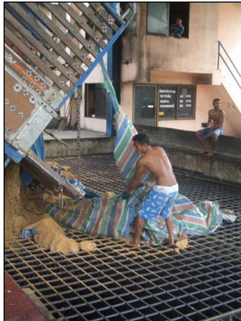
รูปที่ 4.8 การลำเลียงน้ำตาลเข้าคลังสินค้าแบบเทกอง
