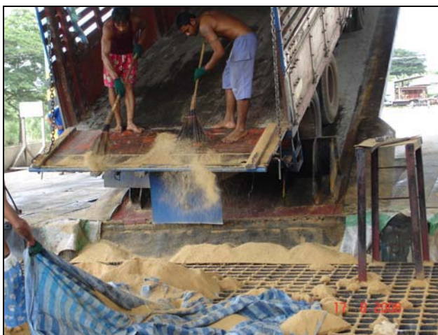
รูปที่ 3.10 การขนถ่ายน้ำตาลแบบเทกองโดยใช้รถบรรทุก (อ่างทองคลังสินค้า)
