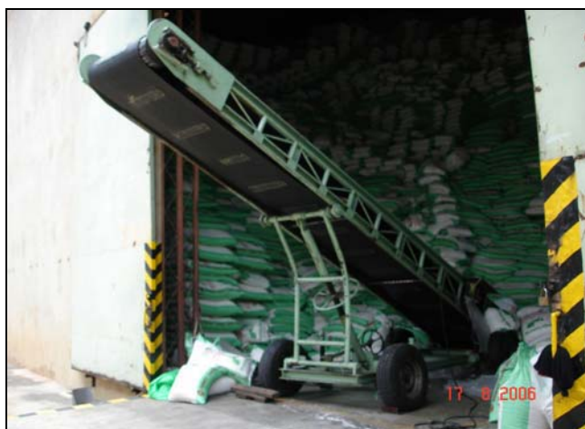
รูปที่ 4.6 สายพานที่ใช้การลำเลียงน้ำตาลจากคลังสินค้าของโรงงานแบบกระสอบ
