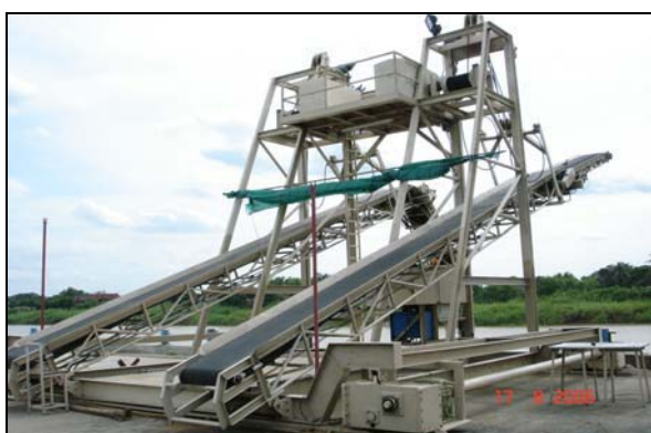
รูปที่ 4.7(1) และ (2) เครื่องลำเลียงน้ำตาลแบบกระสอบลงสู่เรือโป๊ะ
