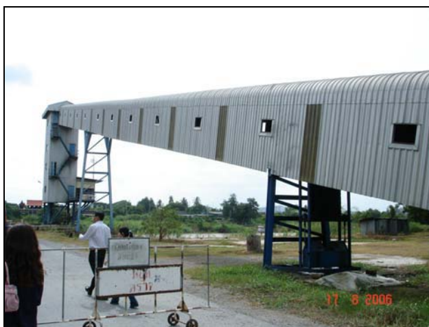
รูปที่ 3.11 อุปกรณ์การขนถ่ายน้ำตาลแบบสายพานลำเลียงลงเรือโป๊ะ (อ่างทองคลังสินค้า)
