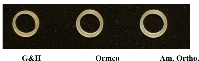
รูปที่ 3.2 รูปร่างและขนาดของแถบยางดึงฟันที่นำเข้าจากต่างประเทศ (มีเส้นผ่านศูนย์กลางประมาณ 6.0 มิลลิเมตร)
