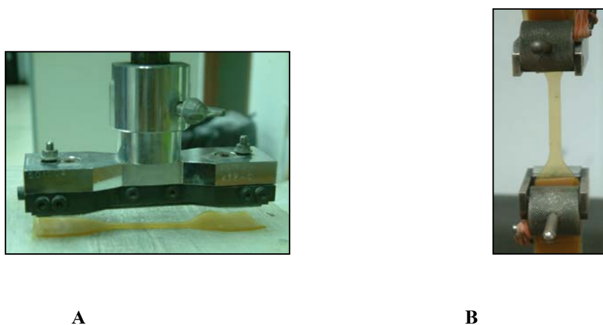
รูปที่ 2. A: ตัวตัดฟิล์มยางรูปดัมเบล B: การทดสอบความทนทานต่อแรงดึง ด้วยเครื่อง Universal Testing machine (Tensometric Co., LTD. England)
