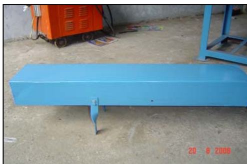
รูปที่ 3.25 ฝาครอบชุดสายพานที่เสร็จสมบูรณ์
