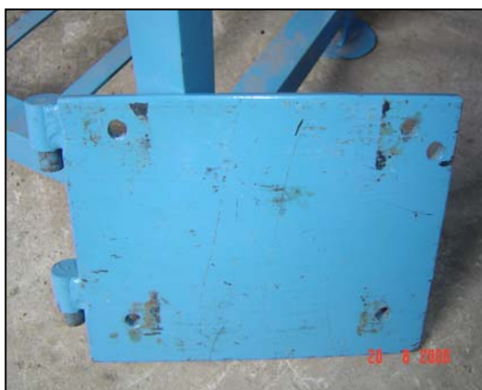
รูปที่ 3.27 ฐานยึดมอเตอร์ที่เสร็จสมบูรณ์
