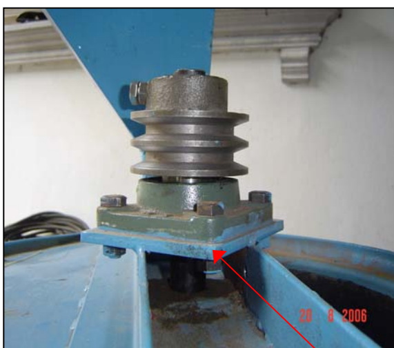
รูปที่ 3.29 แผ่นยึดชุดพูลเลย์ที่เสร็จสมบูรณ์
