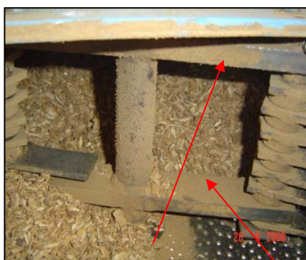
รูปที่ 3.19 ชุดยึดใบมีดบน และชุดยึดใบมีดล่างเสร็จสมบูรณ์
