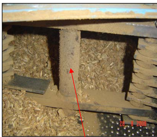
รูปที่ 3.12 เพลาลูกที่เสร็จสมบูรณ์
