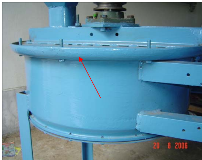
รูปที่ 3.7 ถังป่นเศษไม้ระมัดที่เสร็จสมบูรณ์
