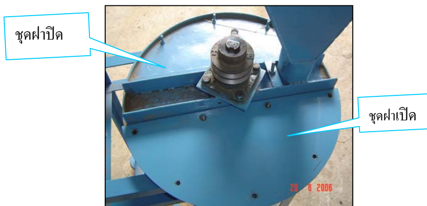
รูปที่ 3.10 ฝาปิด และฝาเปิดเครื่องที่เสร็จสมบูรณ์
