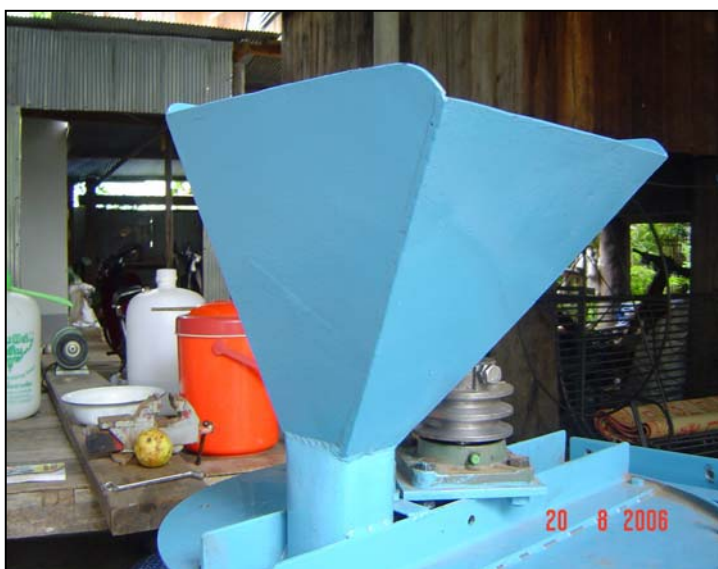
รูปที่ 3.21 ของช่องป้อนเศษไม้มะม่วงที่เสร็จสมบูรณ์
