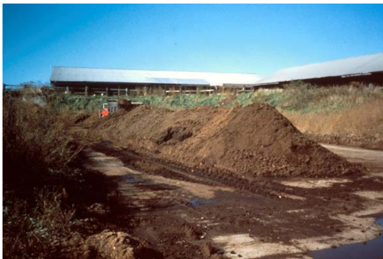
รูปที่ 6 เทคโนโลยีแบบกองแถวสถิตย์ (เทคโนโลยีระดับต่ำ)
