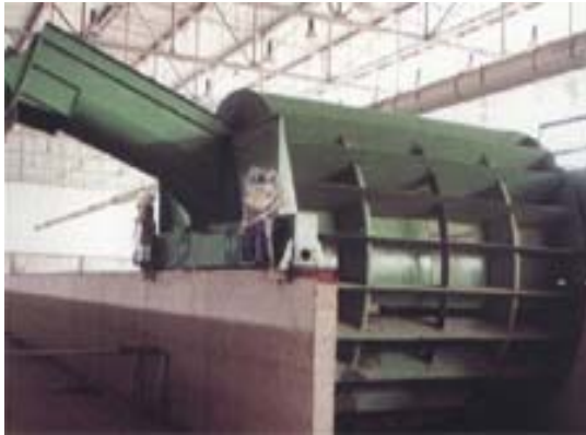
รูปที่ 5 เทคโนโลยีแบบกองแถวพลิกกลับกอง (เทคโนโลยีระดับสูง) by the SILODA
