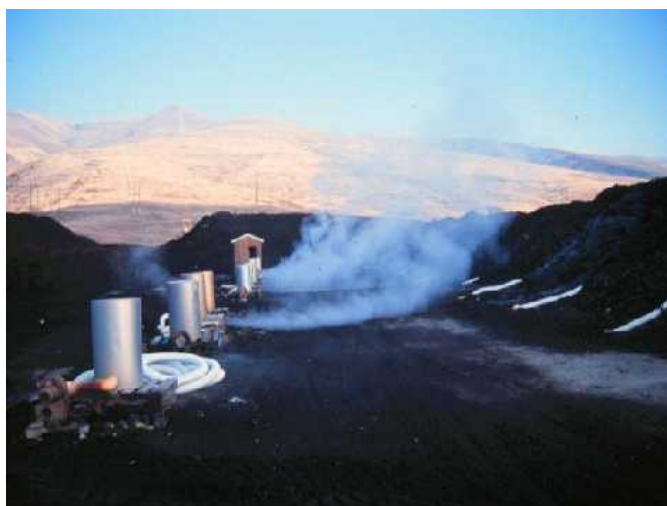
รูปที่ 2.7 การหมักปุ๋ยแบบกองสติดัดอากาศ (Forced Aeration)
