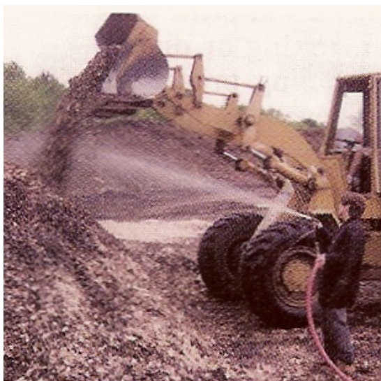
รูปที่ 4 เทคโนโลยีแบบกองแถวพลิกกลับกอง (เทคโนโลยีระดับกลาง)
