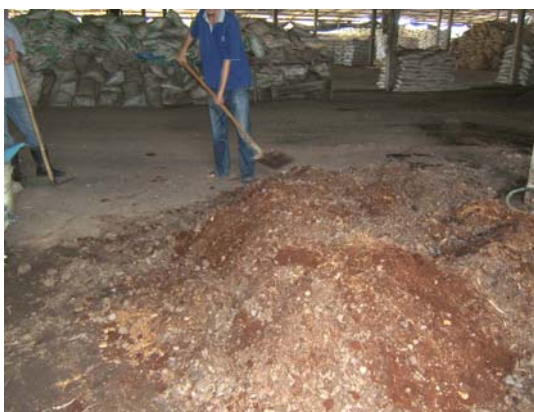
รูปที่ 3 เทคโนโลยีแบบกองแถวพลิกกลับกอง (เทคโนโลยีระดับต่ำ)
