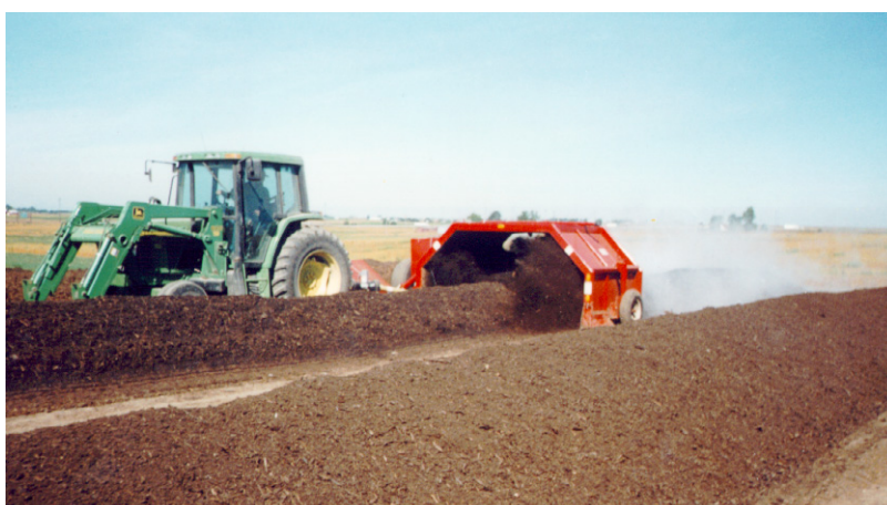
รูปที่ 2.6 การหมักปุ๋ยแบบ Windrow อาศัยเครื่องจักรกล
