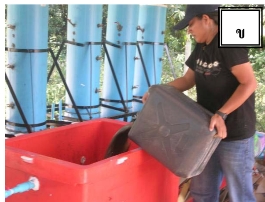
รูปที่ 2-8 การนำเชื้อจุลินทรีย์เริ่มต้นจากบ่อหมักมูลสุกรในฟาร์มสุกร (ก) และการเติมหัวเชื้อลงในระบบสำหรับเริ่มเดินระบบ (ข)
