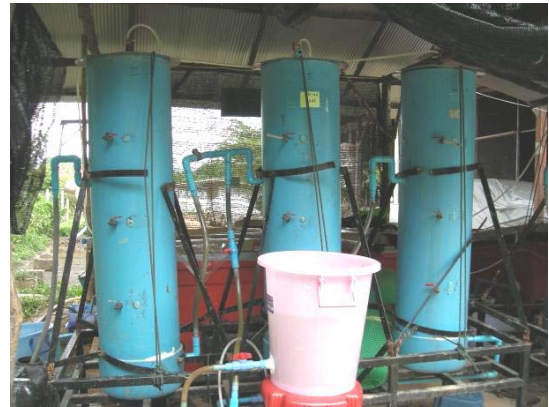
รูปที่ 2-7 ถึงปฏิกรณ์ไร้อากาศแบบแผ่นกันประกยุคต์
