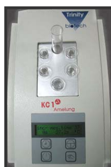
รูปที่ 3.3.1 ภาพซ้ายแสดงเครื่อง Coagulometer (AMELUNG KCI \Delta ) ภาพขวาแสดงถ้วยสำหรับทำปฏิกิริยาในการเกิด fibrin พร้อมกับ ลูกโลหะ (Metal Ball) ที่ถูกจับไว้ด้วยเส้นใย Fibrin
