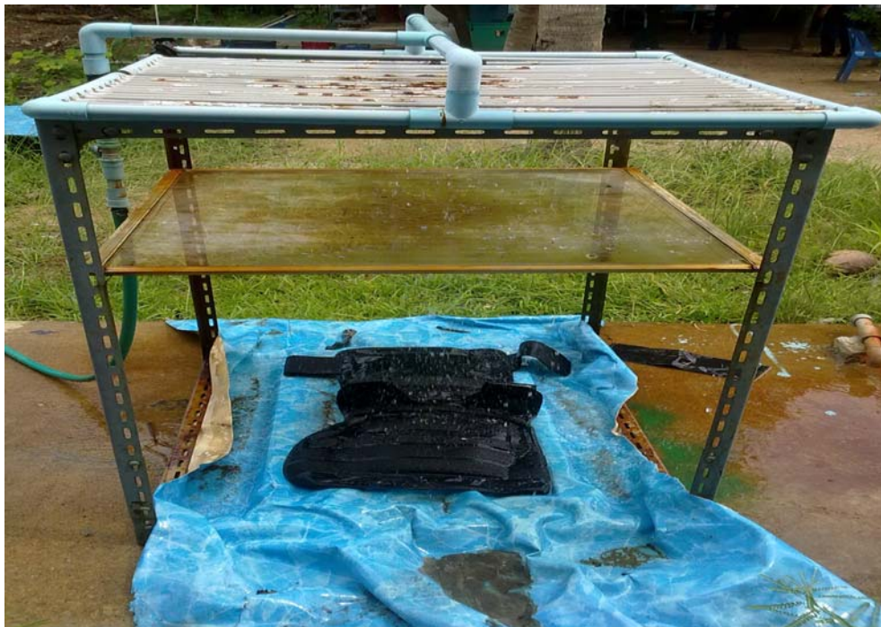
รูปที่ ๔.4 นำชิ้นงานทดสอบพรมน้ำ ด้านละ 3 นาที ก่อนทำการทดสอบ
