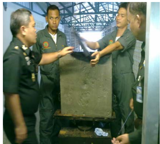
รูปที่ ผ.6 ทำเบาะดินน้ำมัน สำหรับวัดรอยลึกระสุนปืน
