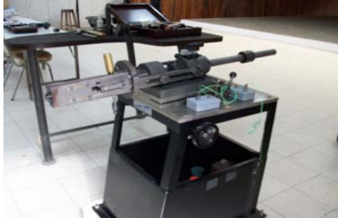
รูปที่ 3 เครื่องยิงทดสอบ Gas gun
