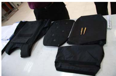
รูปที่ 1 ชุดเกราะสำหรับทดสอบกระสุนปืนพกและเกราะป้องกันกระสุนปืนเล็กยาวที่เป็นอาวุธสงคราม
