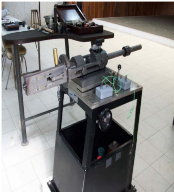
รูปที่ 68 อุปกรณ์ใช้ยิงทดสอบ (Nitrogen gas gun)
