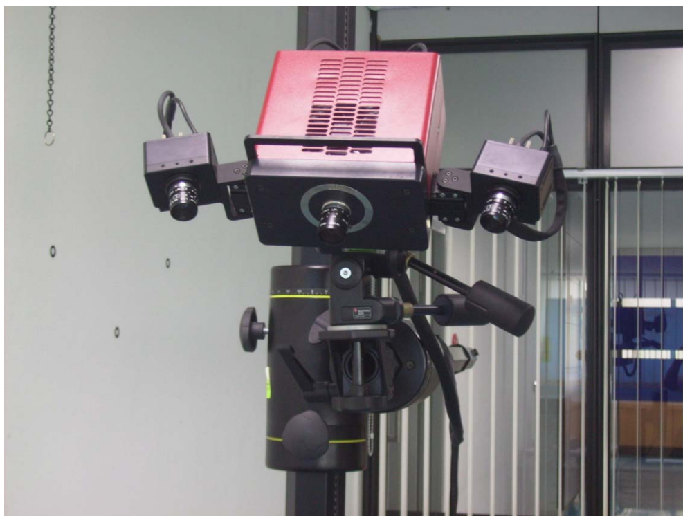
รูปที่ 94 อุปกรณ์กล้อง 3D OPTICAL SCANNING และอุปกรณ์เสริม
