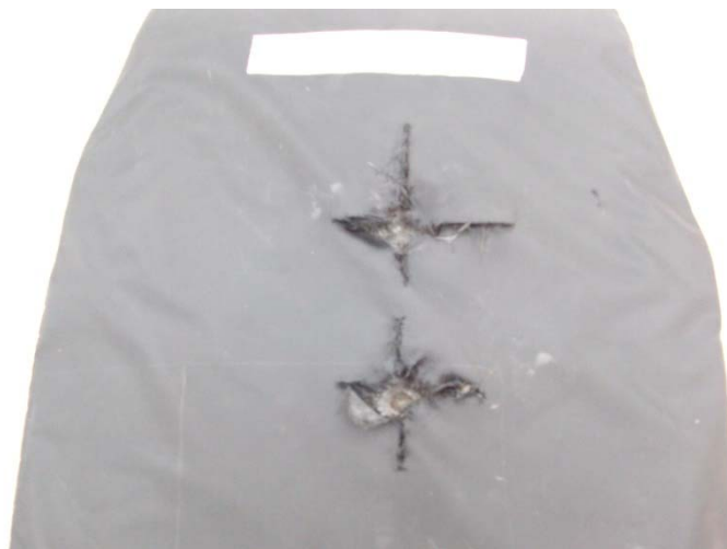
รูปที่ 72 ชุดเกราะปืนพกหลังทำการทดสอบ
