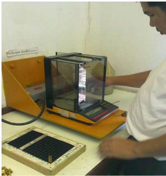
รูปที่ ผ.5 ทำการตวง ชั่ง น้ำหนักกระสุนดินปืน
