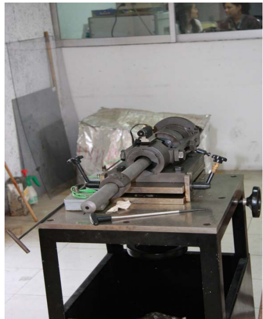
รูปที่ 68 อุปกรณ์ใช้ยิงทดสอบ (Nitrogen gas gun)
