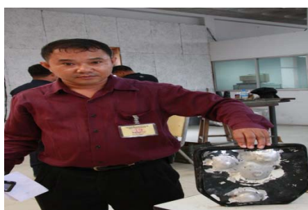
รูปที่ 84 เกราะหลังการยิงทดสอบ
