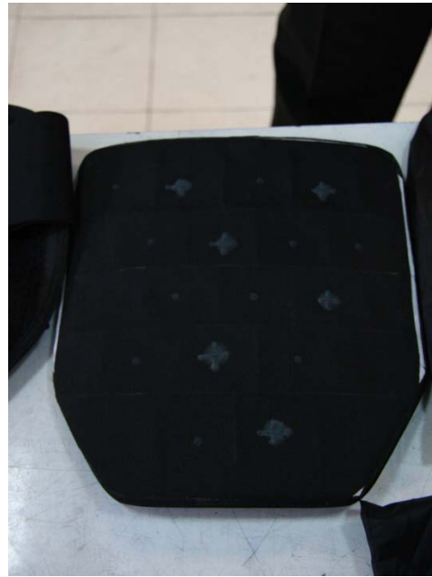
รูปที่ 74 ชุดเกราะสำหรับทดสอบกระสุนปืนเล็กยาวอาวุธสงคราม
