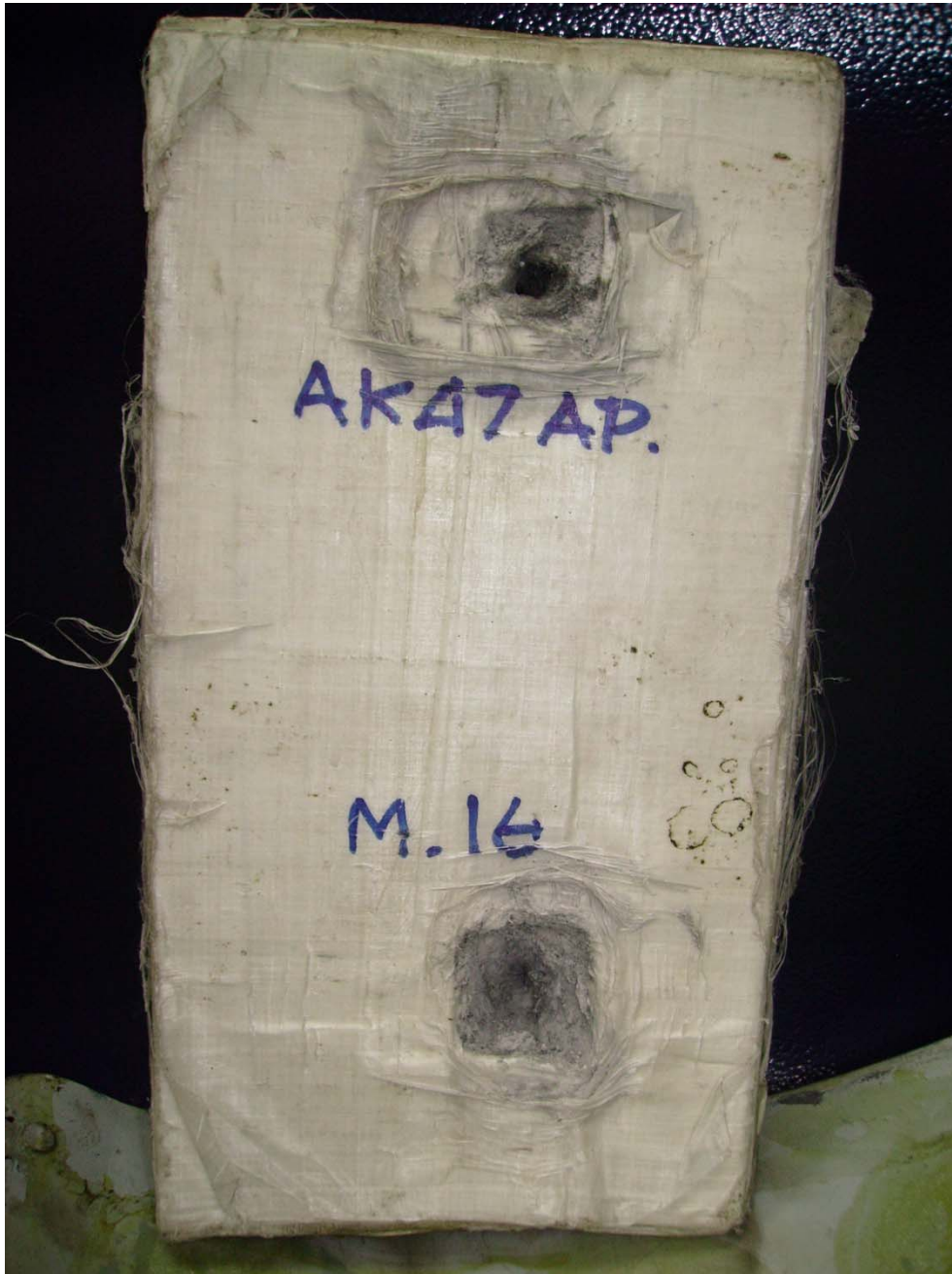
รูปที่ 116 ภาพชิ้นงานที่ทดสอบด้วย กระสุนปืน M16 และ AK47 AP
