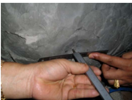
รูปที่ 83 การวัดรอยยูปตัวของดินน้ำมันจากกระสุนปืน M 16 ที่ตำแหน่งที่ 2
