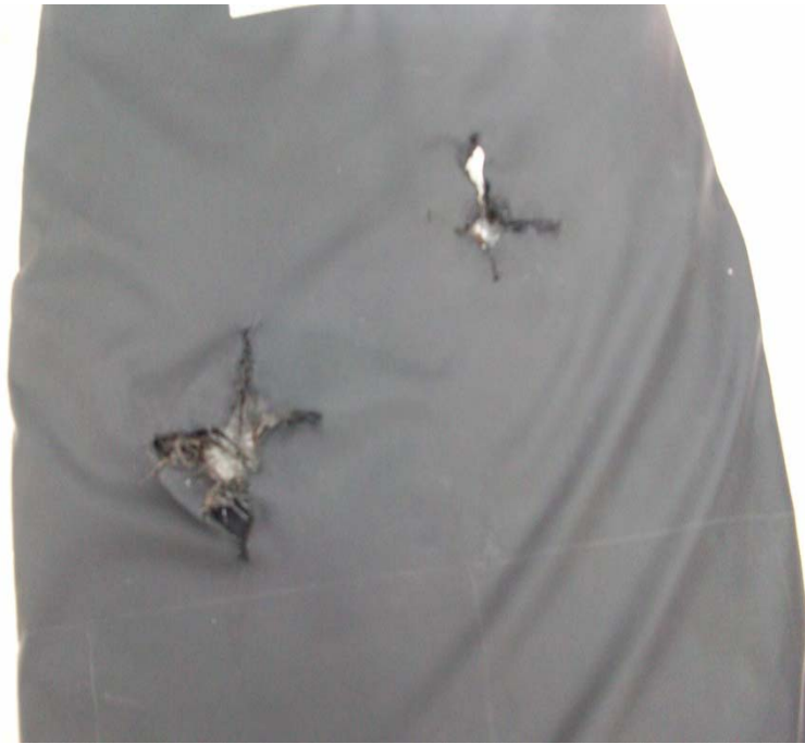
รูปที่ 72 ชุดเกราะปืนพกหลังทำการทดสอบ
