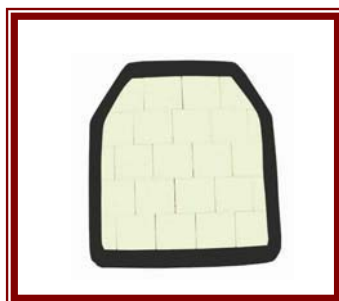
(รูปที่ ๓) แผ่นเซรามิกที่นำมาติดบนใย UDPE อัดแข็ง
