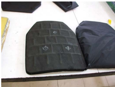
รูปที่ 75 ชุดเกราะสำหรับทดสอบกระสุนปืนเล็กยาวอาวุธสงคราม
