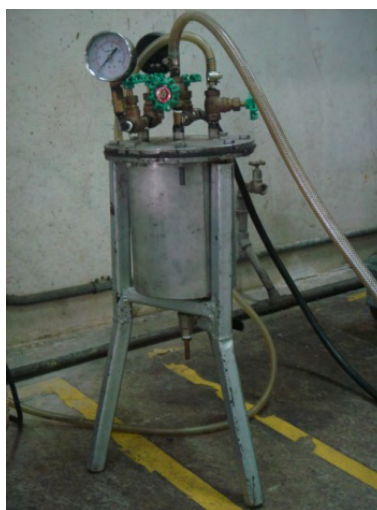
ภาพประกอบที่ 4.4 ตัวถังของชุดอุปกรณ์อาบน้ำไม้ ขนาด 3.5 ลิตร
