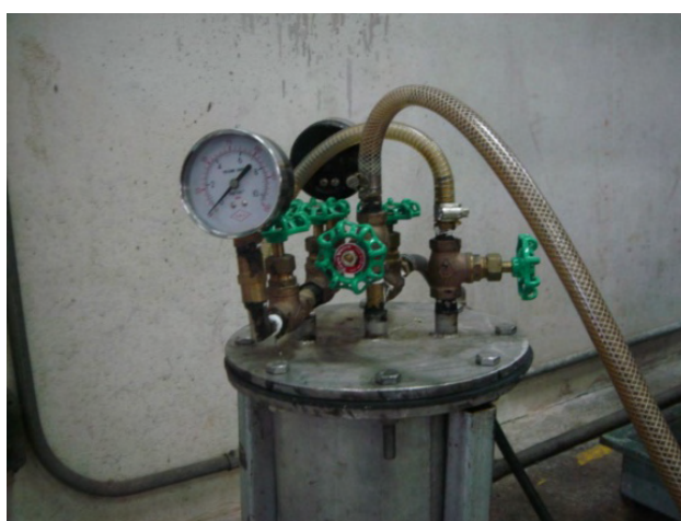
ภาพประกอบที่ 4.5 ฝาทรงของชุดอุปกรณ์อาบน้ำไม้ ขนาด 3.5 ลิตร
