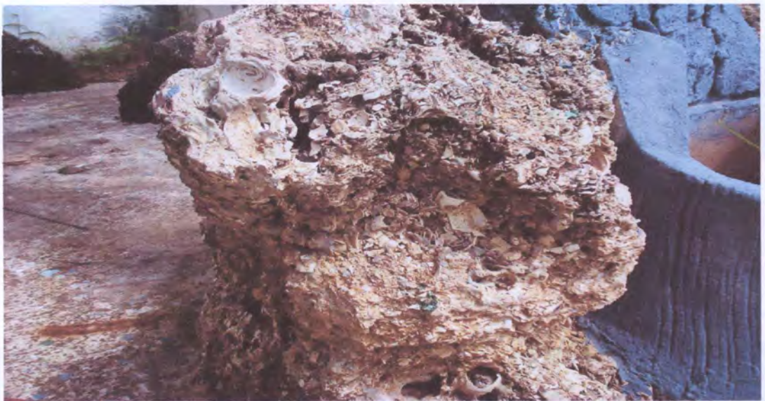
“ซากหอยกลายเป็นหินปูน หรือชิ้นกอิทธิย์ ที่ชุมชนไพรขลาเอามาบดใช้แทนปูนซีเมนต์ใช้ในการสร้าง โบสถ์หลังแรก”
