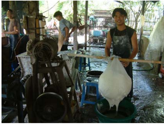
ภาพที่ 46 กระบวนการผลิตขนมจีนบริเวณการผลิตในส่วนของการนวดและกรองแป้ง
