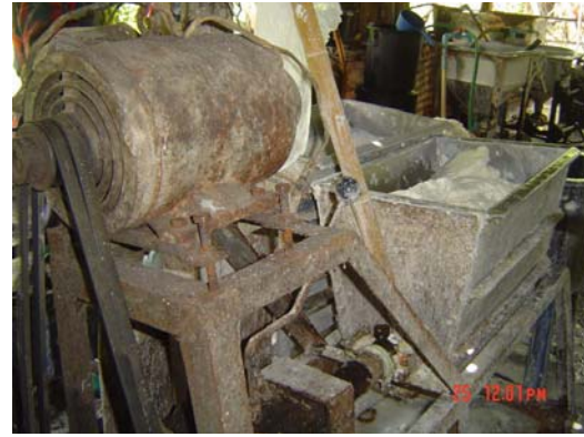
ภาพที่ 46 กระบวนการผลิตขนมจีนบริเวณการผลิตในส่วนของการนวดและกรองแป้ง
