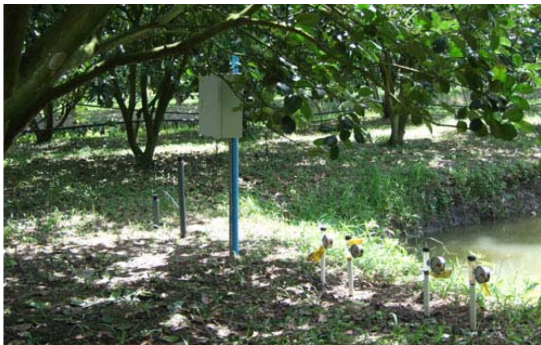
รูปที่ 3-44 การติดตั้ง tensiometer (ขาว) และหัววัดแบบ FDR พร้อมทั้งอุปกรณ์อ่านค่าและบันทึกข้อมูล (ซ้าย) เพื่อวัดความเครียดน้ำในแปลงติดตามธาตุอาหารที่ อ.ปากพอง จ.นครศรีธรรมราช โดย ติดตั้งที่ระดับความลึก 15 และ 45 เซนติเมตร
