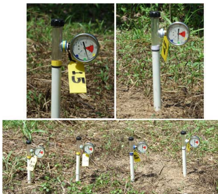
รูปที่ 3-23 การติดตั้ง tensiometer เพื่อวัดความเครียดน้ำในแปลงติดตามธาตุอาหารที่ อ.ลิซล จ.นครศรีธรรมราช (Sic01) โดยติดตั้งที่ระดับความลึก 15 และ 45 เซนติเมตร ระดับความลึกละ 2 อัน
