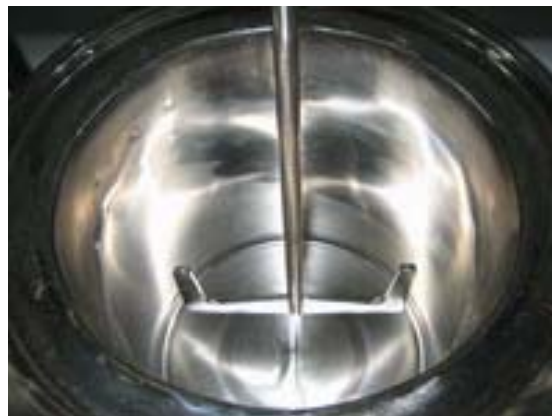
รูป ก2 ถังสเตนเลส 2 ชั้น สำหรับตกผลึกความจุ 6.5 ลิตร และใบกวนสเตนเลสรูปตัวยู (เส้นผ่านศูนย์กลางใบพัด 15 เซนติเมตร ยาว 15 เซนติเมตร และสูง 30.5 เซนติเมตร)
