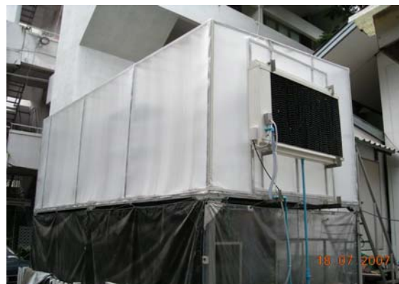
รูปที่ 4.1 โครงสร้างระบบโรงเรือนแบบไอระเหย (green evaporative room)
