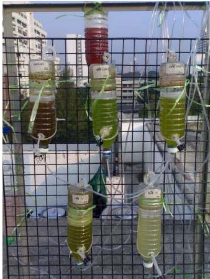
รูปที่ 4.4 ชุดการทดลองการเหนี่ยวนำให้เซลล์จุลสาหร่าย H. pluvialis สะสมสารแอสตาแซนทีน ในถังปฏิกรณ์ชนิดเป่าอากาศแบบกรวย ปริมาตร 1.5 ลิตร ที่ทำการเพาะเลี้ยงนอกห้องปฏิบัติการ
