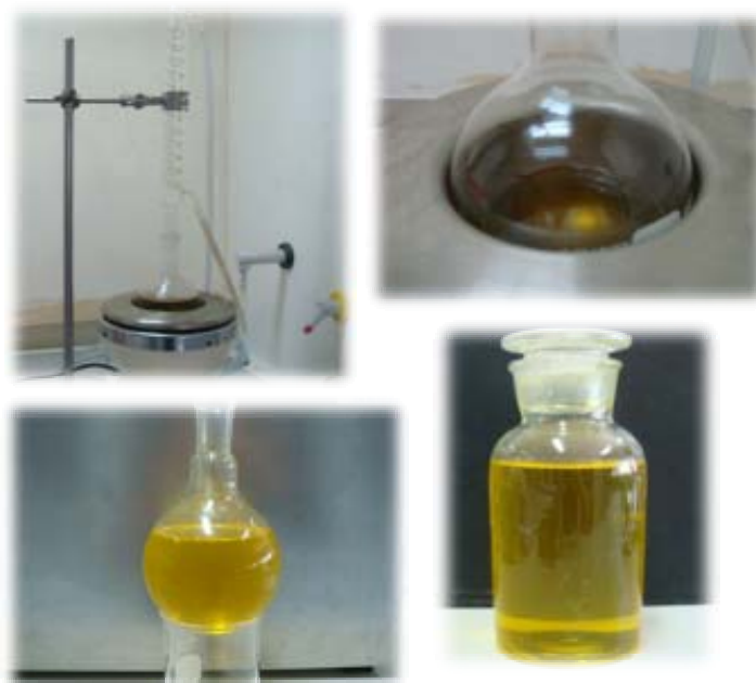
รูปที่ 4.3 การสังเคราะห์ Folin-Ciocalteu's phenol reagent
