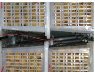
ภาพที่ 64 การเสียบสาย thermocouple ชนิด type T เข้าไปในตะกร้าบรรจุผลล่ำไย และภายในห้องรม \text{SO}_2
