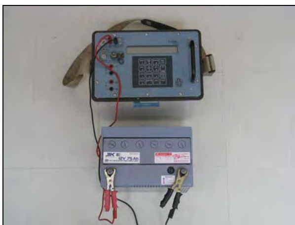
รูป 4.5 เครื่องมือวัดค่าสภาพต้านทานไฟฟ้า รุ่น SYSCAL R1 PLUS Switch-48
