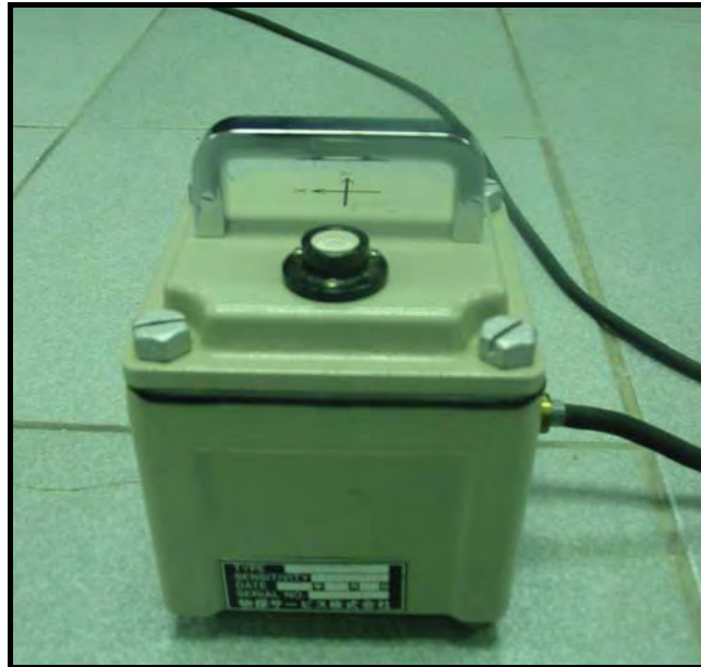
รูปที่ 3.2 หัววัดสัญญาณ (Sensor) CR4.5-2S
