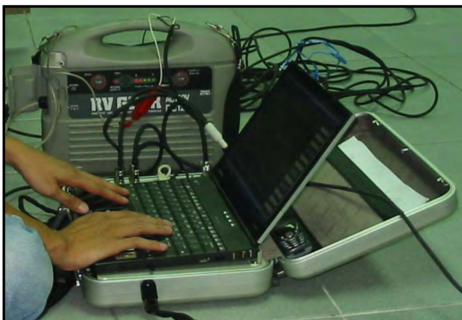
รูปที่ 3.1 อุปกรณ์รับข้อมูล (Data Acquisition Instrument) GEODAS-10-24DS
