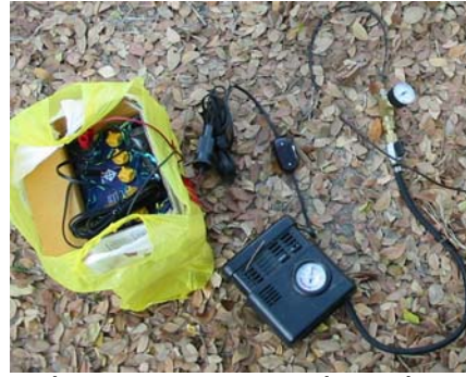
รูปที่ 2.6 การต่อแบตเตอรี่กับเครื่องสูบลม
