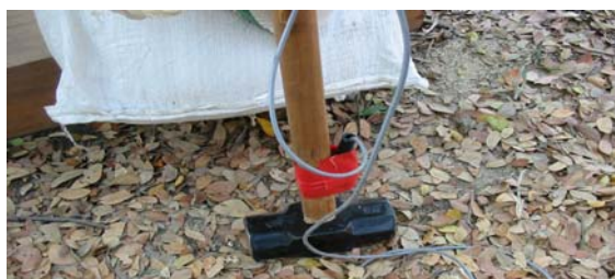
รูปที่ 2.4 การติดตั้งตำแหน่งทรินเกอร์ที่บริเวณด้ามค้อน
