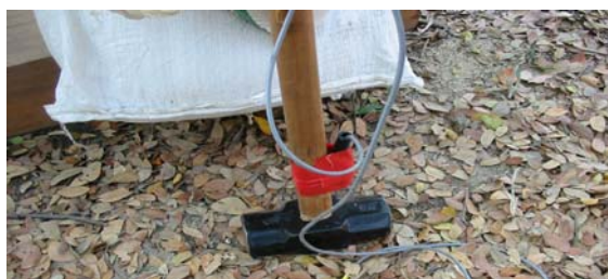
รูปที่ 2.4 การติดตั้งตำแหน่งทริกเกอร์ที่บริเวณด้ามค้อน
