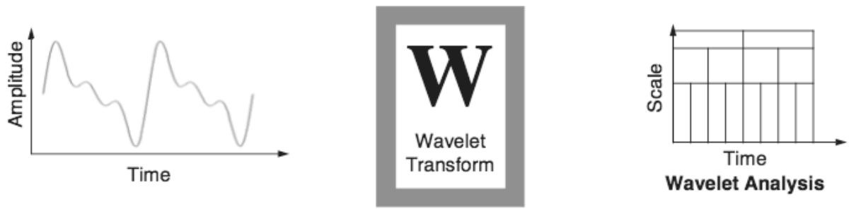
รูปที่ ๖-6 การแปลงเวฟเลต (Wavelet Transform) ที่ประยุกต์มาจากการแปลงเวฟเลตแบบกำหนดหน้าต่าง (STFT) โดยให้ขนาดของหน้าต่างกว้างขึ้นเมื่อวิเคราะห์สัญญาณความถี่ต่ำ และแคบลงเมื่อวิเคราะห์สัญญาณความถี่สูง (ที่มา Misiti, 2007)
