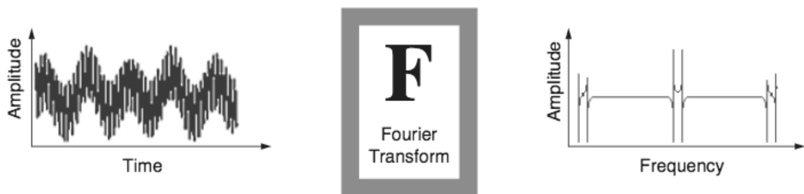
รูปที่ ก-3 การแปลงฟูเรียร์จากข้อมูลอนุกรมของสัญญาณในมิติของเวลามาเป็นข้อมูลในมิติของความถี่ (ที่มา Misiti, 2007)
