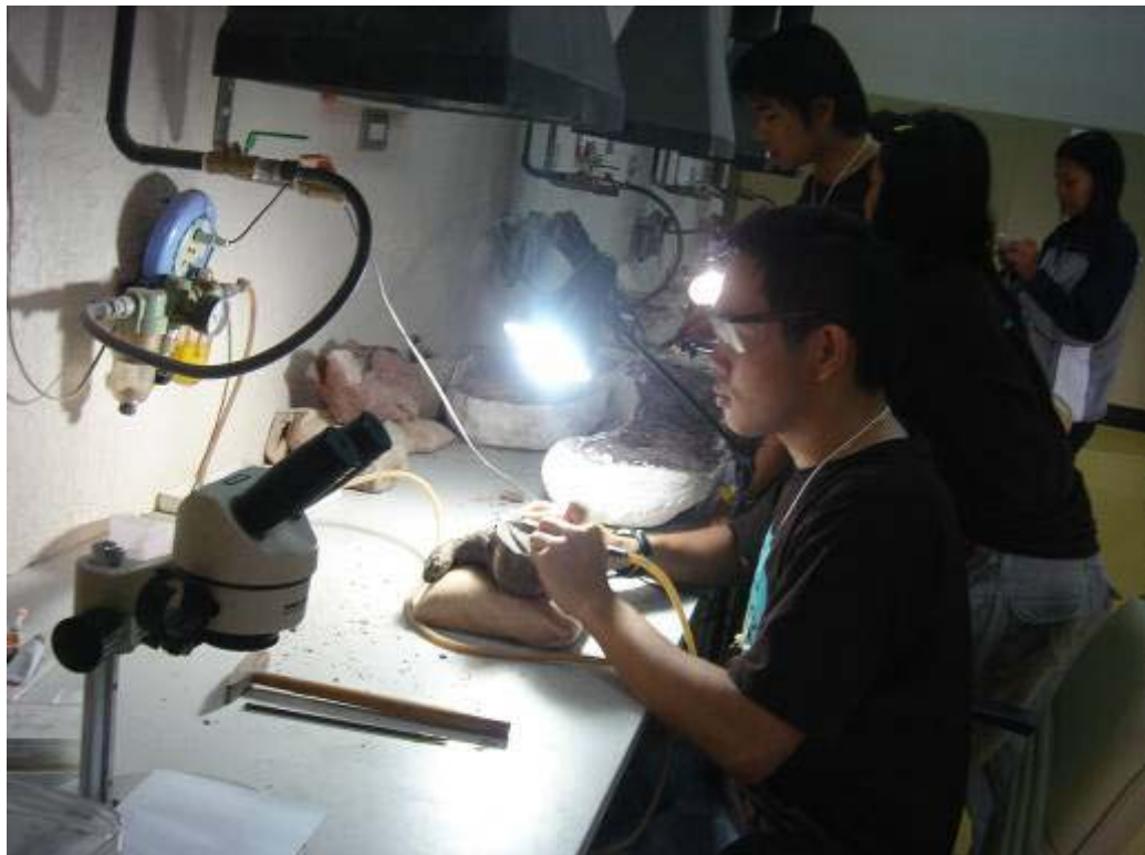
รูปที่ 15 การสกัดหินออกจากกระดูกโดยปากกาลมในห้องปฏิบัติการ
