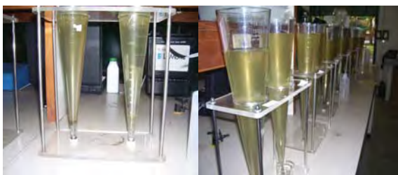
ภาพที่ 2 การปรับปรุงคุณภาพน้ำตัวอย่างโดยการตกตะกอน
