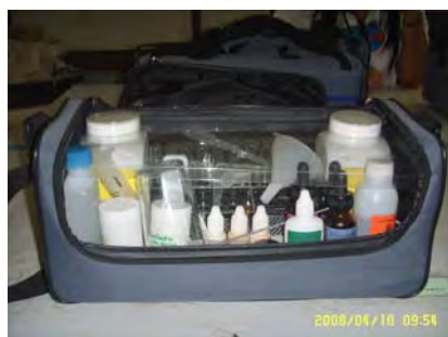
ภาพที่ 8 ชุดตรวจสอบธาตุอาหารในดิน (Soil Test Kit)
