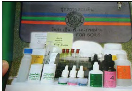
ภาพที่ 2 แสดงชุดตรวจสอบธาตุอาหารในดินอย่างง่าย (Soil test kit)
