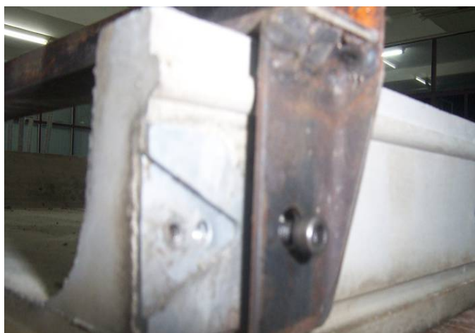
ภาพที่ 5.2 ภาพขยายสลักเกลียวยึดชุดอุปกรณ์จับรูปตัวซีกับแผ่นผนังสำเร็จรูป
