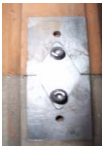
ภาพที่ 4.6 ภาพการเลื่อนออกจากกันของชุดต่อผนังหลังการทดสอบโดยไม่เกิดการแตกร้าว
