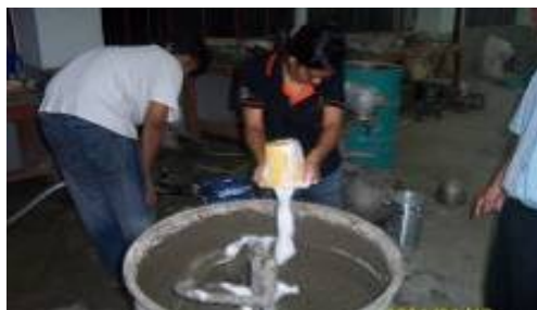
ภาพที่ 3.2 แสดงระบบผลิตCLCคอนกรีตระดับอุตสาหกรรมและการผลิตขนาดเล็ก
