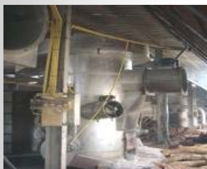
เตาเผาเพื่อกำเนิดลมร้อนที่ใช้ฟืนเป็นเชื้อเพลิง ช่าย-เตาไอร้อนโดยการเผาเหล็กให้ร้อน และ ขวา-เตาต้มน้ำสร้างไอน้ำเพื่อแลกเปลี่ยนสร้างเป็นลมร้อนในเตาอบแห้ง
