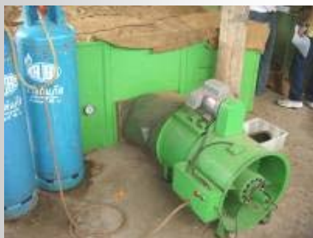
เครื่องอบแห้งแบบกระเปาะใช้ความร้อนจากแก๊สหุงต้ม
