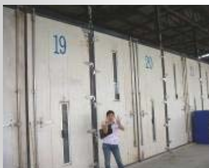
เตาอบแบบไอร้อน และไอน้ำที่สร้างโดยใช้วัสดุห้องเย็นเป็นผนังห้องอบแห้ง
