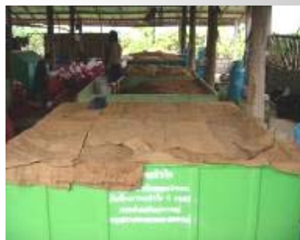
เครื่องอบแห้งแบบกระเปาะใช้ความร้อนจากแก๊สหุงต้ม
