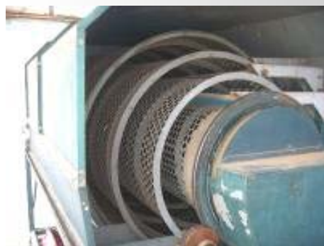
เครื่องร้อนคัดเกรดลำไย ช่าย-ขนาดเล็ก และชวา-ขนาดใหญ่
