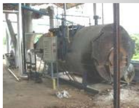
เตาเผาเพื่อกำเนิดลมร้อนที่ใช้ฟืนเป็นเชื้อเพลิง ช่าย-เตาไอร้อนโดยการเผาเหล็กให้ร้อน และ ขวา-เตาต้มน้ำสร้างไอน้ำเพื่อแลกเปลี่ยนสร้างเป็นลมร้อนในเตาอบแห้ง
