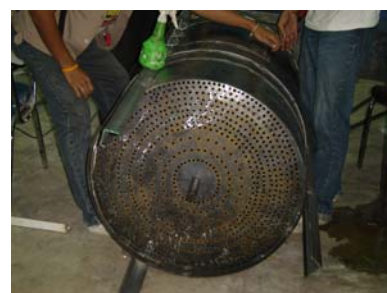
รูปที่ 5 ขนาดของรูลมเครื่องคัดแยกเมล็ดนุ่น
