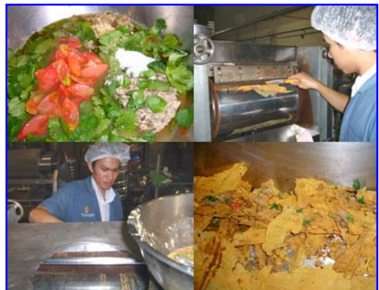
ภาพที่ 4 กระบวนการผลิตต้มยำปลาทูน่ากิ่งสำเร็จรูป ด้วยเครื่องอบแห้งแบบลูกกลิ้ง
