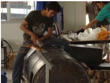
รูปที่ 7 การตกแต่งก่อนลงสีกันสนิม
