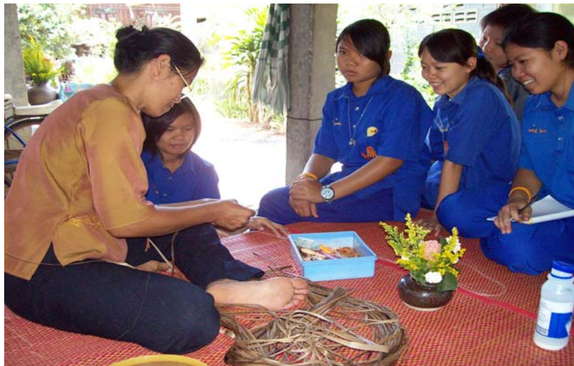
ขั้นตอนการชัก/ดึงเส้นใยจากกาบใบกล้วยจนวล
