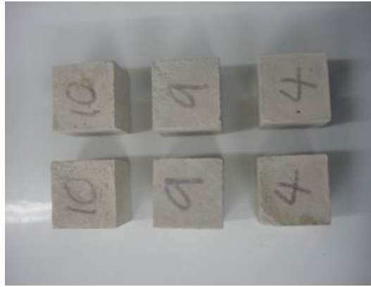
ภาพที่ 2 ตัวอย่างทดสอบมอร์ตาร์
