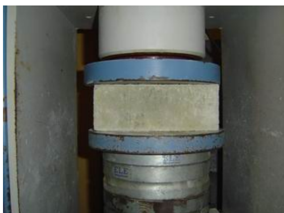
ภาพที่ 3-13 ทดสอบการกดตัวอย่าง
