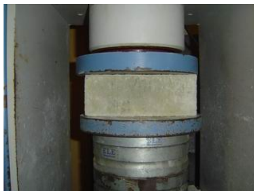
ภาพที่ 5 การทดสอบกำลังอัดประลัยของบล็อกประสานปูพื้น
