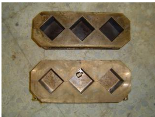
ภาพที่ 1 แบบหล่อทองเหลือง ขนาดมาตรฐาน ASTM C 109 / C 109 M-99 [4]
