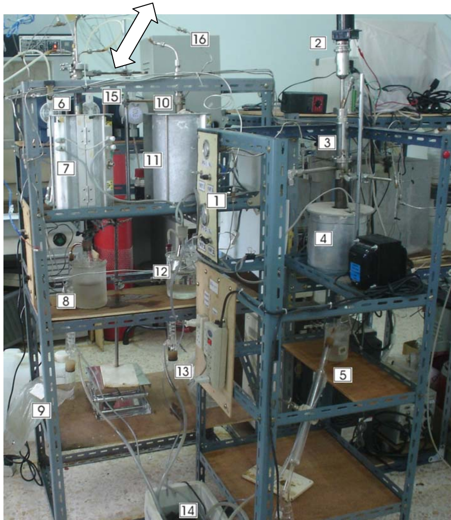
รูปที่ 4.22 เครื่องต้นแบบที่สามารถบำบัดน้ำเสียได้ 0.5 ลิตรต่อชั่วโมง ประกอบด้วยชุดไพโรไลซิสแบบเบดเคลื่อนที่, ชุดทำปฏิกิริยาน้ำมันส่วนใส และชุดทำปฏิกิริยาน้ำมันส่วนชั้น
