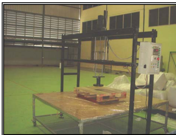
รูปที่ 13 เครื่องทดสอบความแข็งของฟองยางพารา
