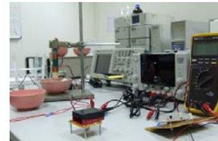
รูปที่ 26. การวัดความเข้มข้นน้ำยางโดยใช้เครื่องวัดชนิดไมโครเวฟและอุปกรณ์การวัดทุกกระบวนการ
