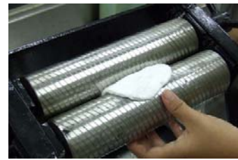
รูปที่ 21. การชั่งน้ำหนัก การจับตัวอย่าง และการรีดยาง ในการหาความเข้มข้นน้ำยางมาตรฐาน
