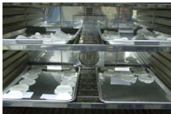
รูปที่ 22. การอบและชั่งน้ำหนักในการหาความเข้มข้นน้ำยางมาตรฐาน
