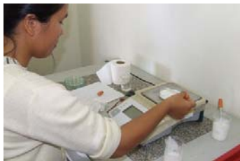
รูปที่ 21. การชั่งน้ำหนัก การจับตัวอย่าง และการรีดยาง ในการหาความเข้มข้นน้ำยางมาตรฐาน
