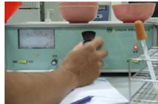
รูปที่ 26. การวัดความเข้มข้นน้ำยางโดยใช้เครื่องวัดชนิดไมโครเวฟและอุปกรณ์การวัดทุกกระบวนการ
