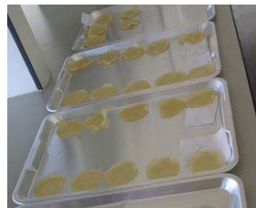
รูปที่ 22. การอบและชั่งน้ำหนักในการหาความเข้มข้นน้ำยางมาตรฐาน
