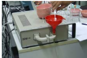
รูปที่ 26. การวัดความเข้มข้นน้ำยางโดยใช้เครื่องวัดชนิดไมโครเวฟและอุปกรณ์การวัดทุกกระบวนการ
