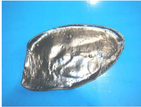
รูปที่ 11 ยางคอมพาวด์ที่ได้หลังการผสมวัตถุดิบตามสูตร
