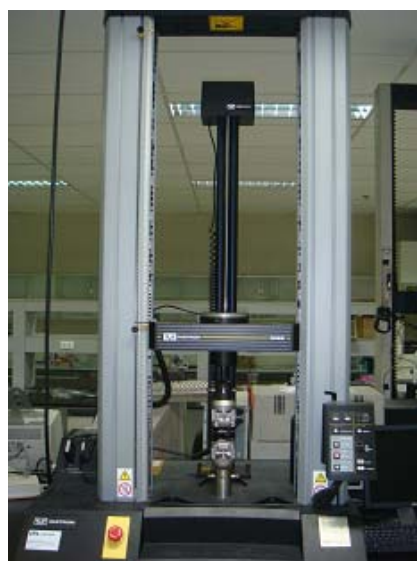
รูปที่ 14 เครื่องทดสอบสมบัติการรับแรงดึง Universal Testing Machine
