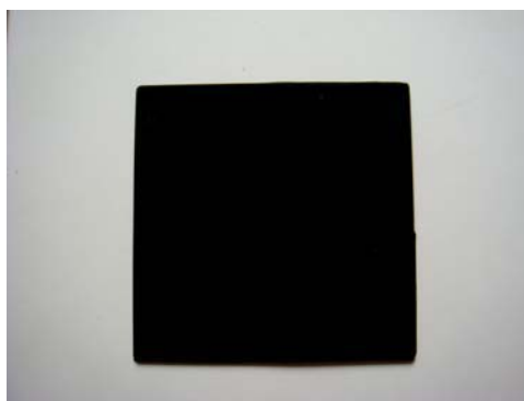
รูปที่ 12 ชิ้นงานยางคงรูป/ขนาด 200×200×2.5 มิลลิเมตร
