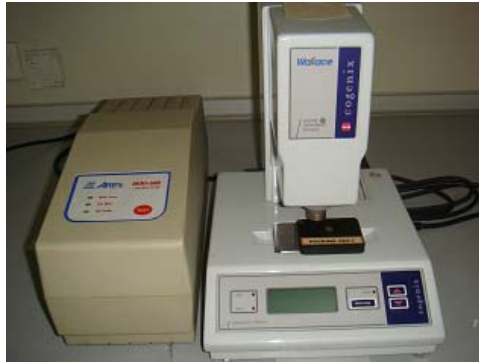
รูปที่ 13 เครื่องดูโรมิเตอร์สำหรับวัดความแข็งในหน่วยชอร์ตามมาตรฐาน ASTM D2240
