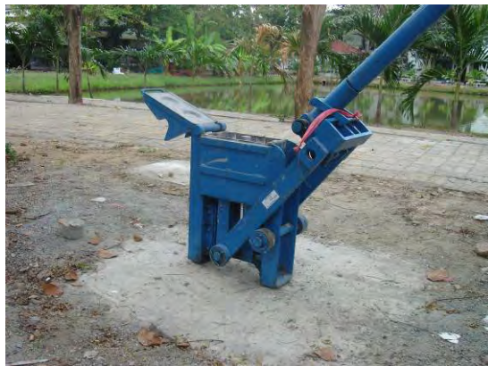
รูปที่ 7 เครื่องอัดคอนกรีตบล็อก
