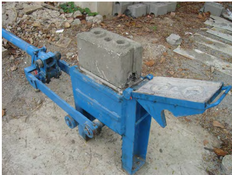
รูปที่ 9 การนำก้อนคอนกรีตบล็อกออกจากเครื่องอัด
