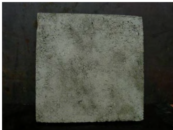
รูปที่ 14 ตัวอย่างสำหรับทดสอบค่าสัมประสิทธิ์การนำความร้อน ขนาด 30x30x1.5 ลูกบาศก์เซนติเมตร
