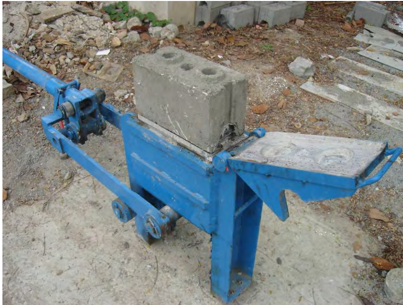
รูปที่ 2 การนำก้อนคอนกรีตบล็อกออกจากเครื่องอัด
