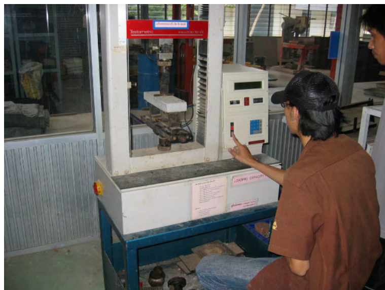
รูปที่ 12 การทดสอบกำลังดัดคอนกรีตบล็อก
