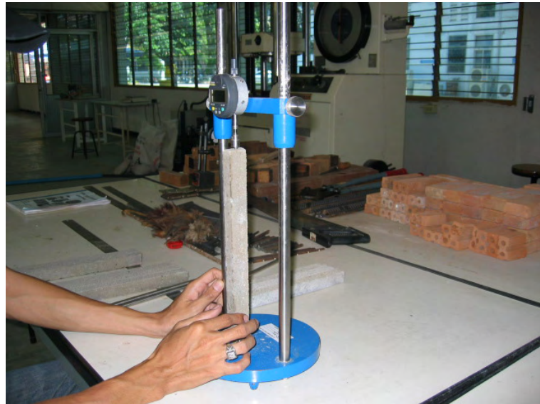
รูปที่ 13 การทดสอบอัตราการเปลี่ยนแปลงความยาวของคอนกรีตมวลบล็อก
