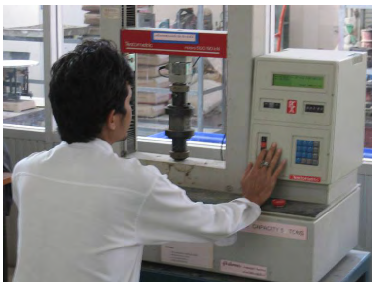
รูปที่ 11 การทดสอบกำลังอัดคอนกรีตบล็อก
