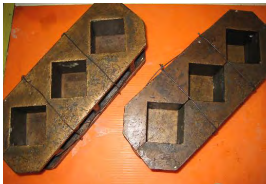
รูปที่ 5 แบบหล่อทองเหลืองขนาด 5 \times 5 \times 5 ลูกบาศก์เซนติเมตร
