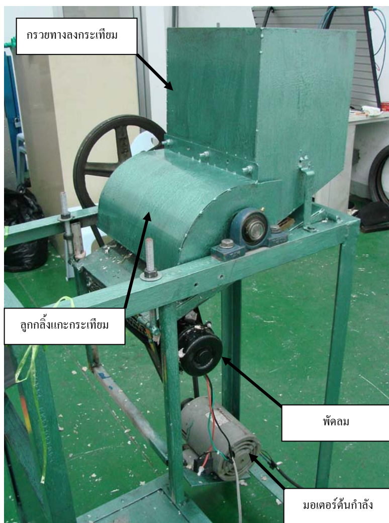
รูปที่ 8. เครื่องแกะกระเทียมที่จัดสร้างขึ้น เพื่อใช้ในการทดสอบการใช้งานลูกกลิ้งยาง
