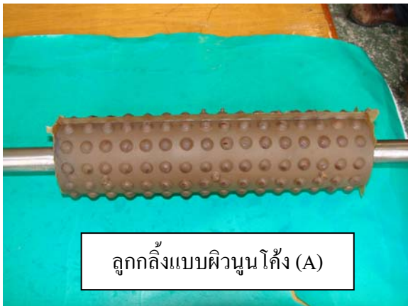
รูปที่ 4. ขั้นตอนการอัดขึ้นรูปลูกกลิ้งยาง
