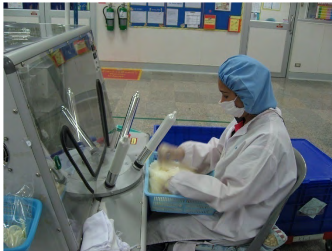
รูปที่ 16 เครื่องตรวจสอบรูรั่วของถุงยางโดยการตรวจสอบการรั่วไหลของกระแสไฟฟ้า
