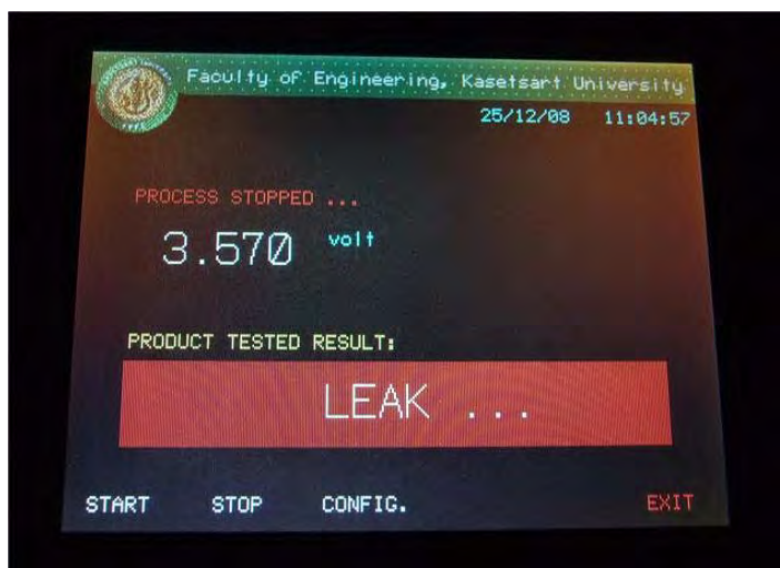
รูปที่ 40 หน้าจอสัมผัสแสดงผลการทดลองระบุว่าถุงมือยางรั่ว
