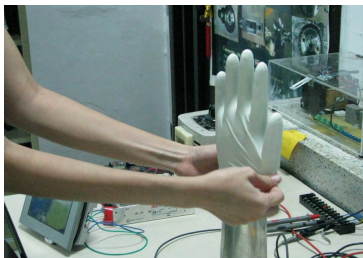
รูปที่ 38 แสดงการสวมถุงมือยางลงบนแม่แบบรูปมือ
