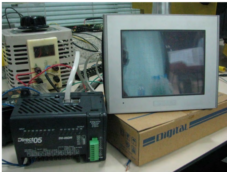
รูปที่ 31 เครื่องควบคุมวงจรตรรกะและหน้าจอสัมผัส
