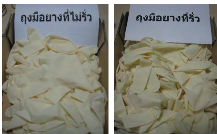
รูปที่ 44 ถุงมือยางที่ถูกแยกประเภทด้วยวิธีการตรวจสอบด้วยการรั่วไหลของกระแสไฟฟ้า
