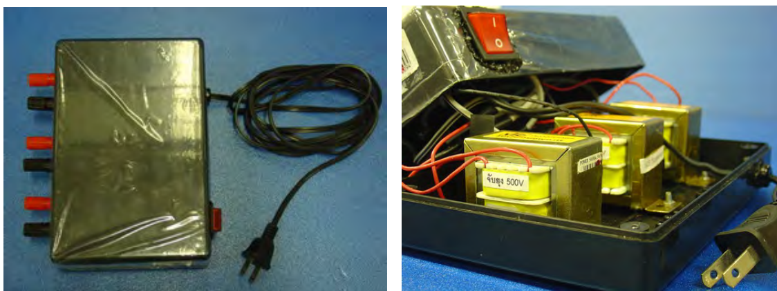
รูปที่ 21 กล่องหม้อแปลงไฟฟ้า
