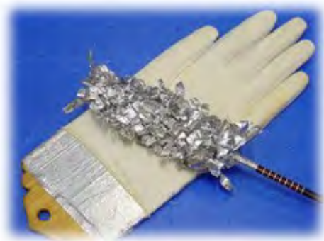
รูปที่ 24 แบบจำลองอุปกรณ์ตรวจสอบรูรั่วของถุงมือยางแบบใช้แปรงกลิ้งทดสอบ
