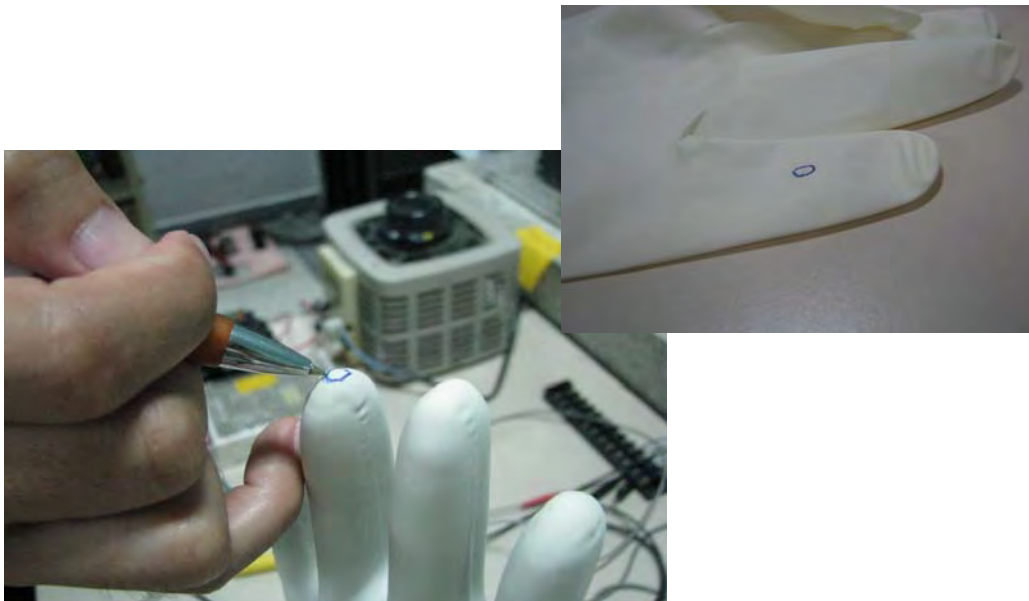
รูปที่ 43 การทำเครื่องหมายแสดงตำแหน่งรูรั้วที่ตรวจสอบพบ
