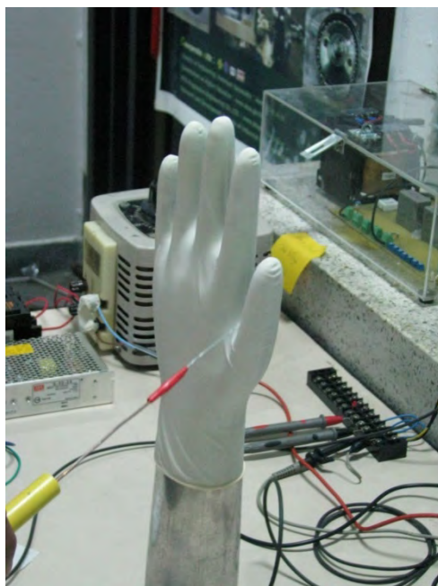
รูปที่ 39 แสดงการผูกแขนงนำไฟฟ้าเพื่อตรวจหาการรั่วบนถุงมือยาง
