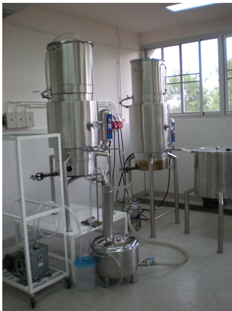
รูปที่ 2 ชุดเครื่องมือทดลองเกี่ยวกับเครื่องพาสเจอร์ไรส์นมแบบ tubular heat exchanger
