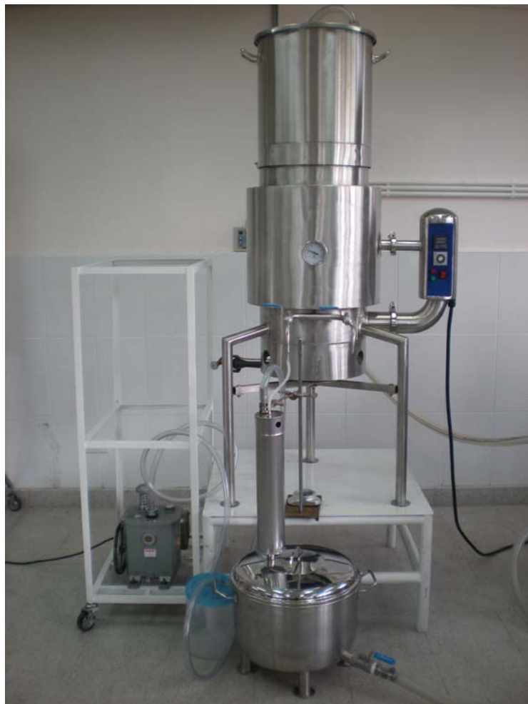
รูปที่ 1 ชุดเครื่องมือลดกลิ่นที่ให้ความร้อนนมด้วย tubular heat exchanger และผ่านนมเข้ากระจกที่มีหัวสเปรย์และมีท่อดูดอากาศ
