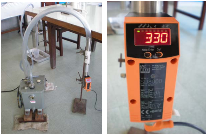
รูปที่ 9 เครื่องวัดอัตราการไหลของอากาศที่ออกจากปั๊มสุญญากาศ
