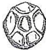
รูปที่ 2.5 ลักษณะ โครงสร้างของเซลล์ปิด (Closed cell) [12]
