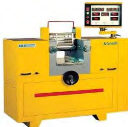
รูปที่ 3.4 เครื่องบดสองลูกกลิ้ง (LABTECH รุ่น LRM-S-200)
