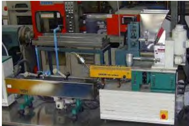
รูปที่ 3.7 เครื่องอัดรีดเกลียวหนอนคู่ (Thermo PRISM รุ่น TSE-16-TC)
