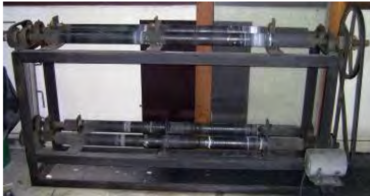
รูปที่ 3.3 ภาพแสดงเครื่องบดลูกกลิ้งหรือเครื่องบดลึง (Ball mills machine)
