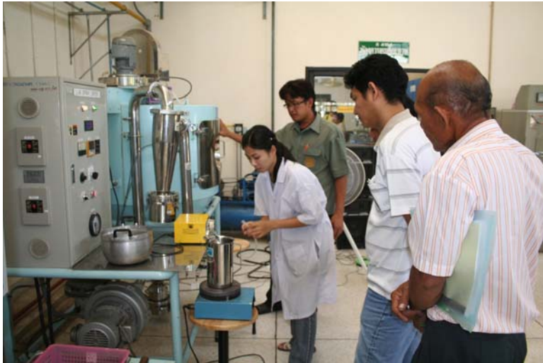
ภาพที่ 72. การเตรียมตัวอย่างสำหรับป้อนเข้าเครื่องอบแห้งแบบพ่นฝอย
