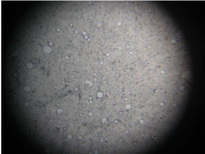
ภาพที่ 24. ขนาดและรูปร่างของครีมเทียมเหลวสูตร B เมื่อส่องด้วยเครื่อง Light Microscope
